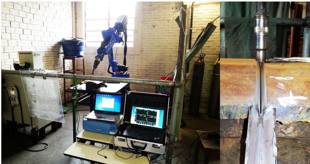
Figura 14 – Aparato experimental utilizado na soldagem.
