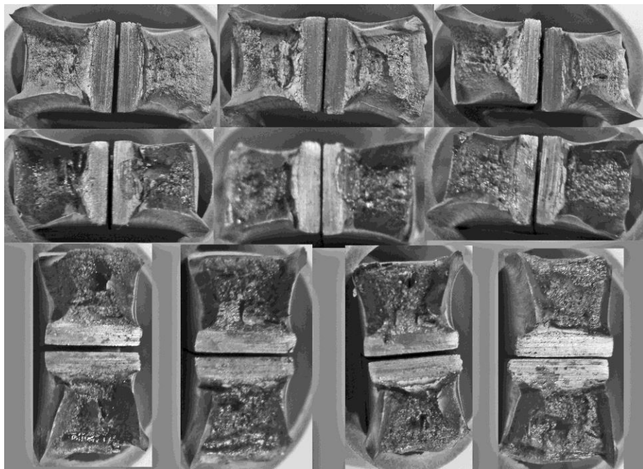
Figura 80 - Fotografias das superfícies de fratura do ensaio Charpy-V, dos corpos de prova soldados com 150 °C de pré-aquecimento.
