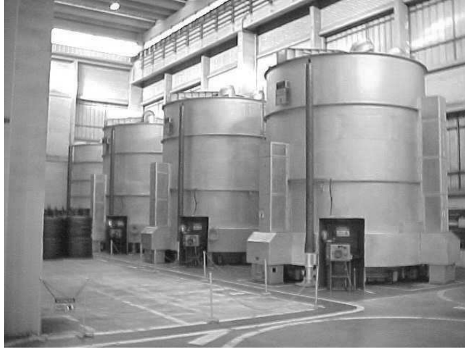
Figura 3.1 Fornos Industriais do tipo Campânula utilizados para os tratamentos de recozimento e esferoidização na Gerdau AEB - Charqueadas.
