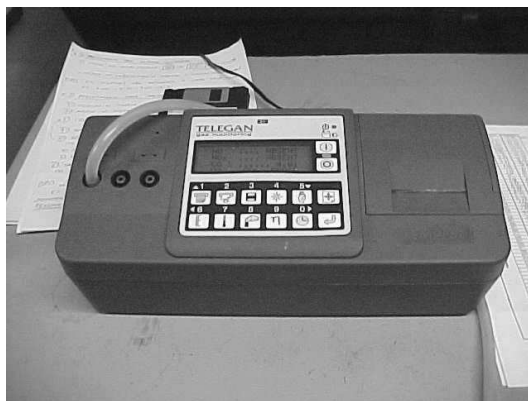
Figura 3.5 Medidor de CO utilizado nos fornos tipo campânula.
