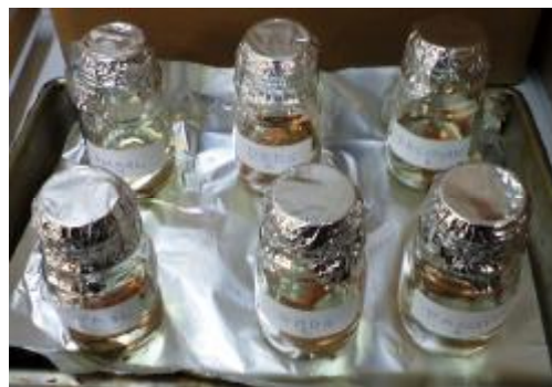
Figura 34 – Amostras de cobre nu e isolados imersos no óleo antes do envelhecimento
