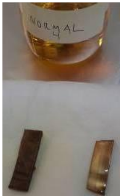
Figura 51 – Amostras de cobre isolado (1) e nu (2) imersas em óleo normal após teste de aquecimento, dentro do frasco (a) e fora do frasco (b)
