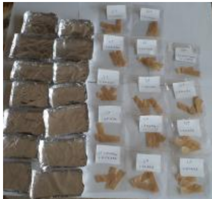
Figura 33 – 42 amostras de papel Kraft, 03 de cada uma das 14 camadas
