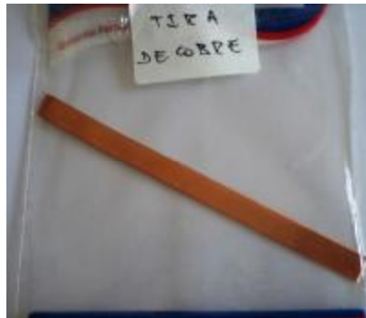
Figura 31 – Segmento da tira de cobre utilizada na confecção das espiras dos transformadores
