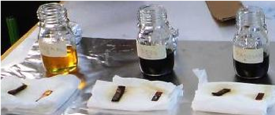
Figura 50 – Amostras de óleos, tiras de cobre nu e isolado após envelhecimento por 72 h em estufa a 140°C
