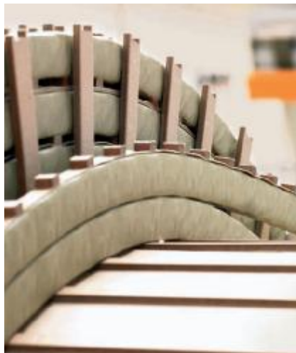
Figura 4 – Manufatura dos enrolamentos do transformador [17]
