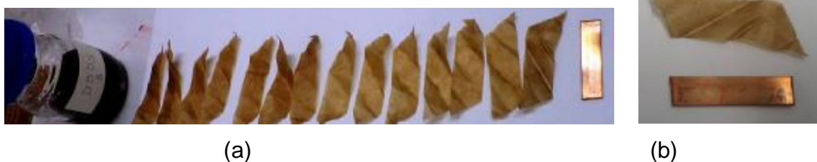
Figura 54 – Papel Kraft isolante aberto, retirado da amostra de OMI inibido com DBDS, após teste de aquecimento. 14 camadas (a) e 14ª camada (b)
