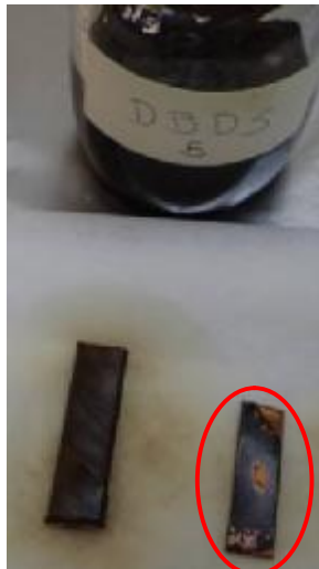
Figura 52 – Amostras de cobre isolado (1) e nu (2) retirados de frascos com óleo inibido com DBDS após teste de aquecimento
