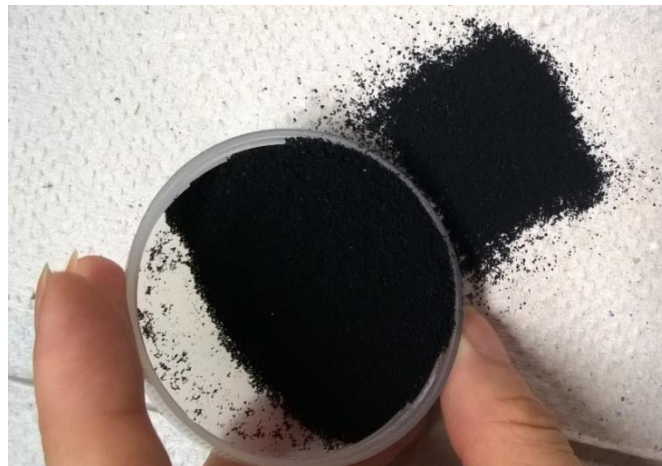
Figura 19. Borracha de pneu em pó Plabor 100/420. Fonte: autor.
