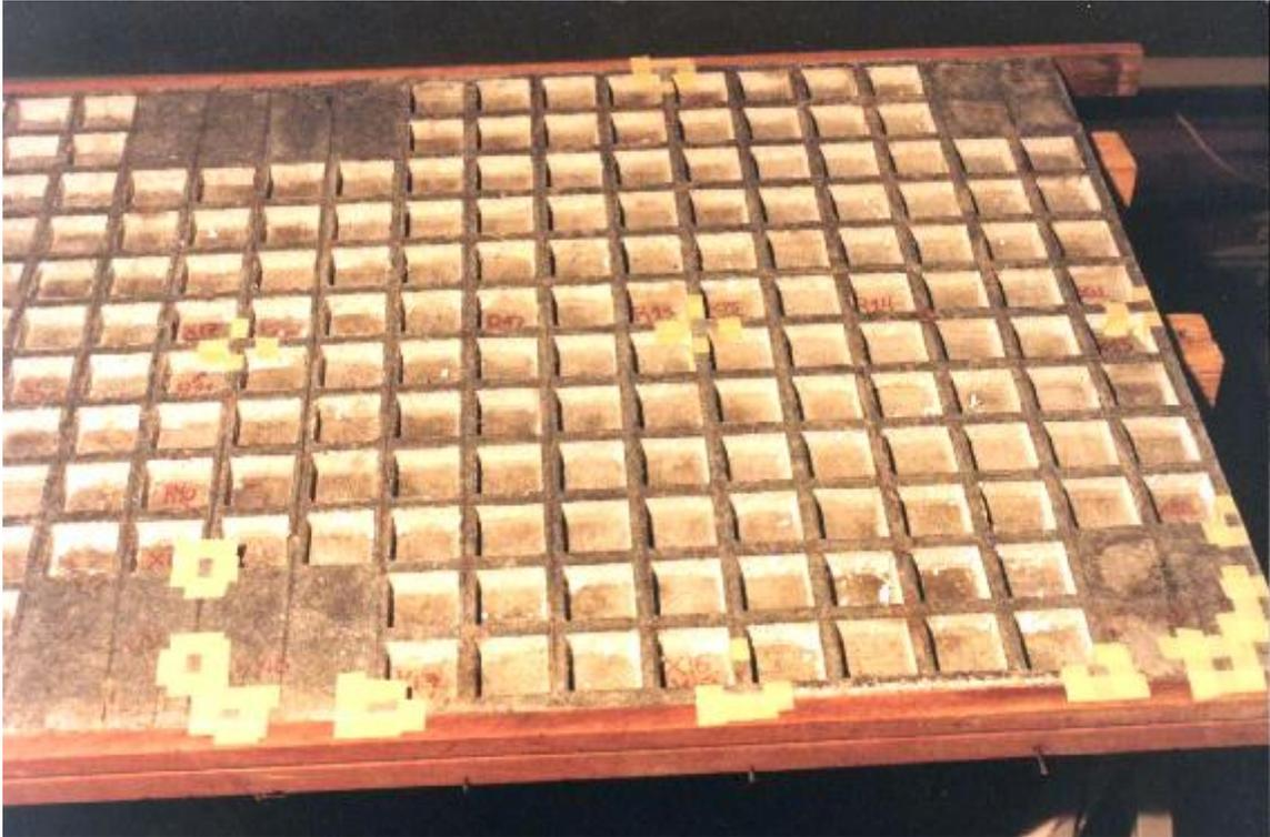
Foto 3.23 - Marcação da superfície inferior da laje para colagem dos extensômetros
