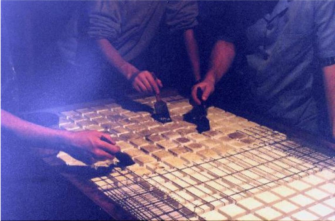
Foto 3.13 - Aplicação de desmoldante na fôrma
