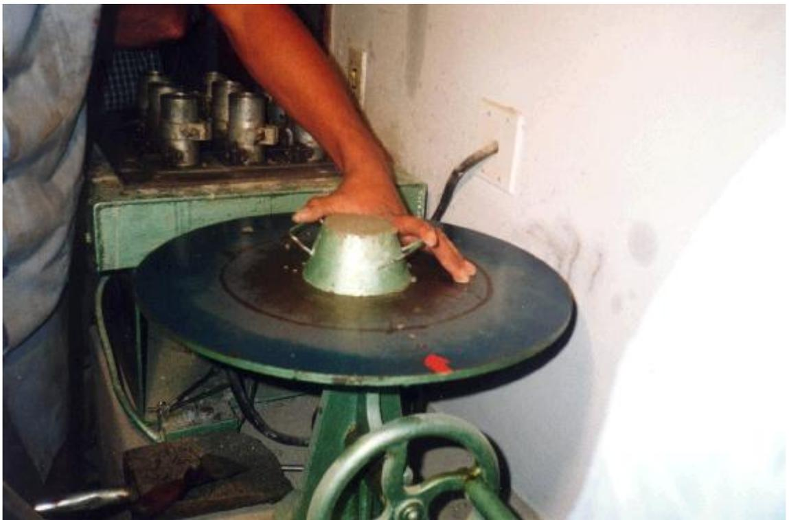
Foto 3.34 - Vista do cone de microconcreto moldado sobre a mesa giratória
