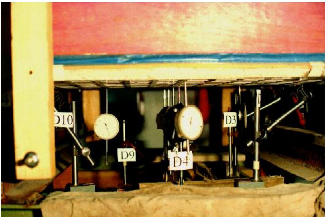
Foto 3.29 - Vista de alguns deflectômetros posicionados sob a laje
