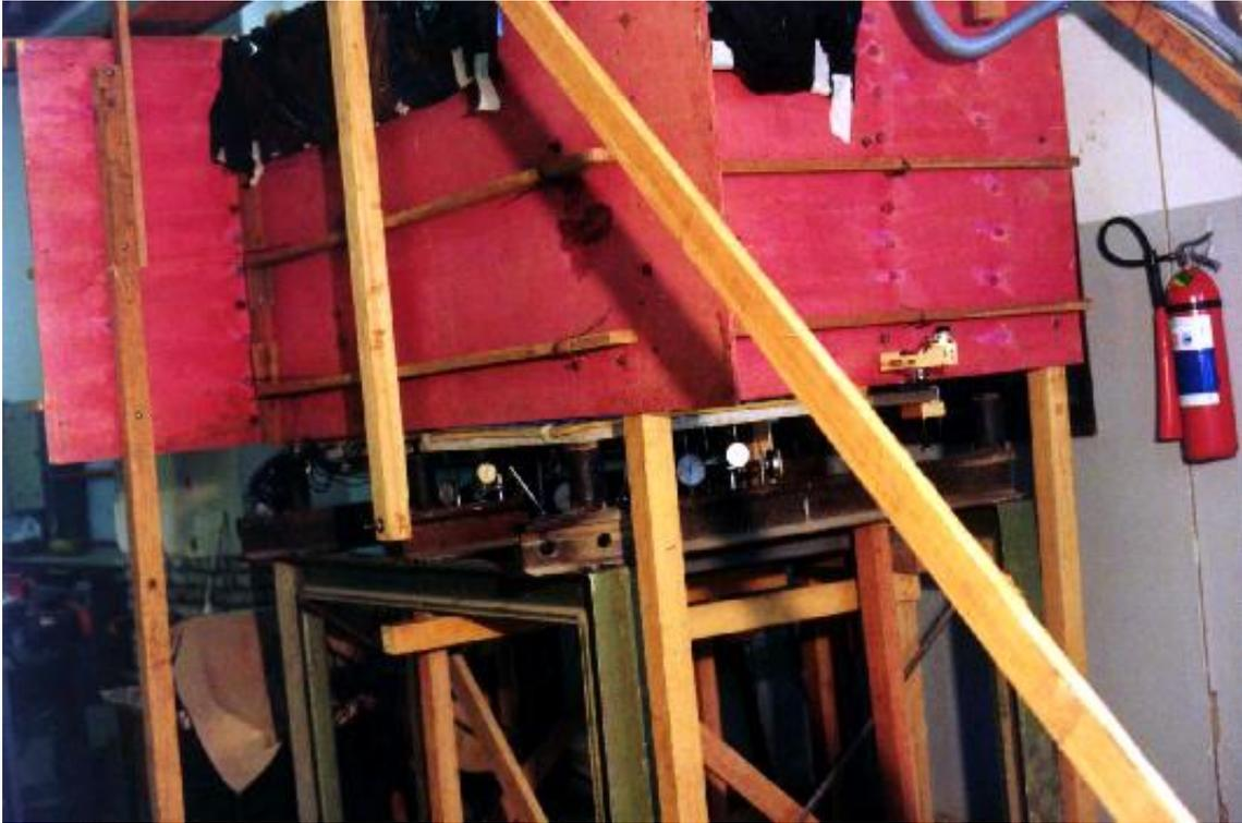
Foto 3.28 - Vista do modelo pronto para o ensaio, com a instrumentação finalizada e a piscina montada sobre ele
