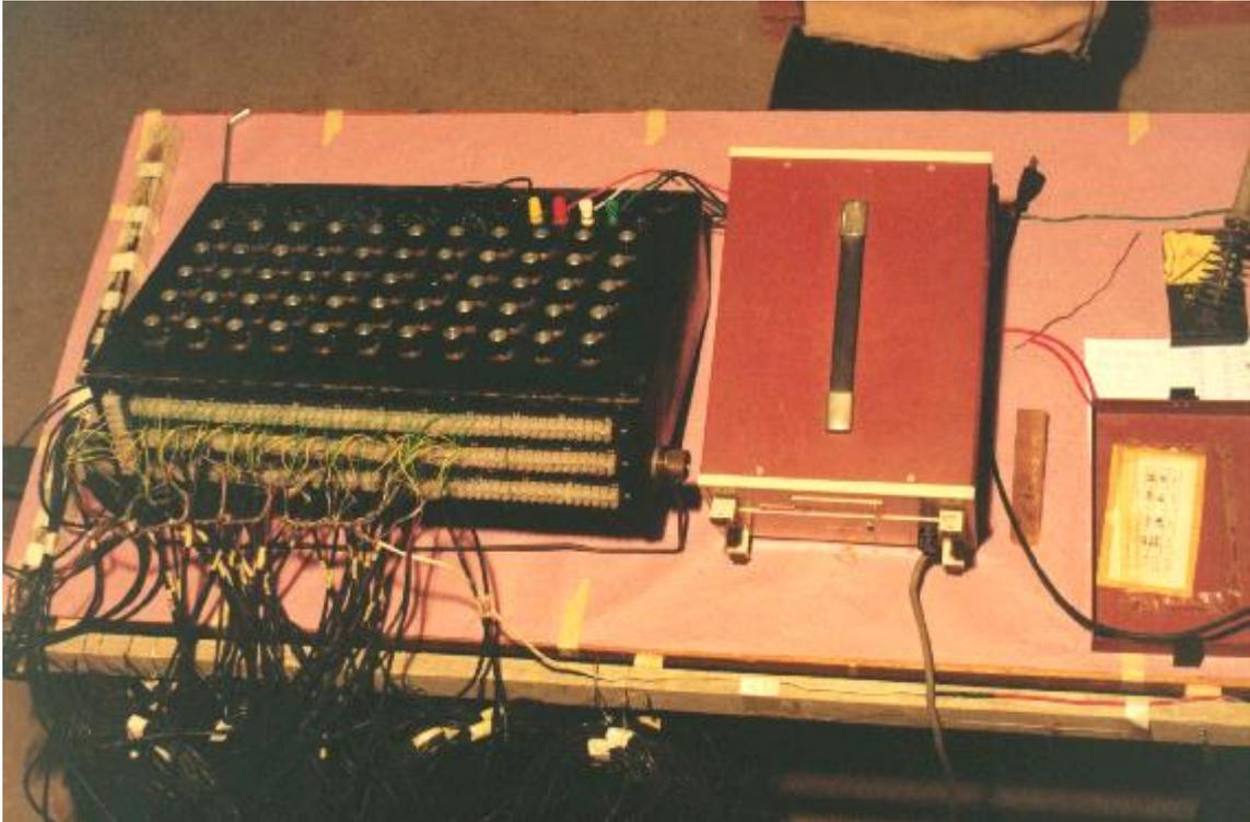
Foto 3.33 - Vista da conexão dos cabos aos equipamentos de leitura e dos extensômetros de referência (à esquerda) colados num elemento de microconcreto isento de tensões
