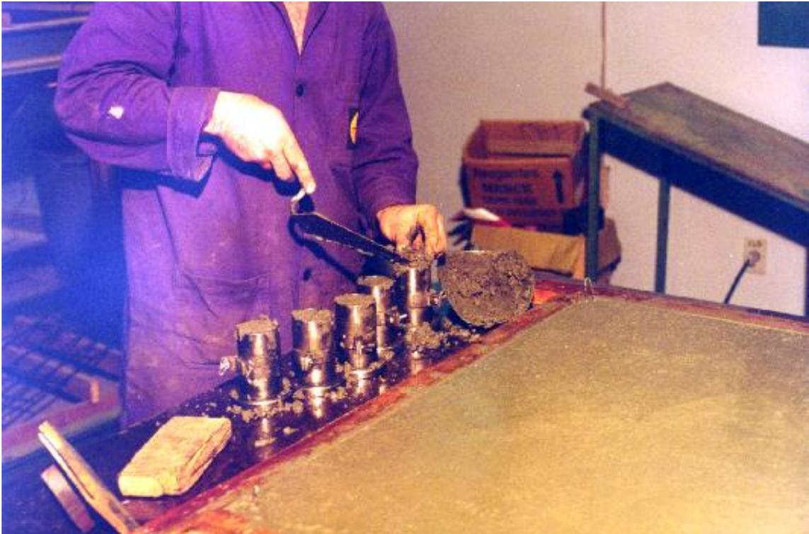
Foto 3.18 - Moldagem dos corpos de prova cilíndricos de  $\phi 5 \times 10$  cm
