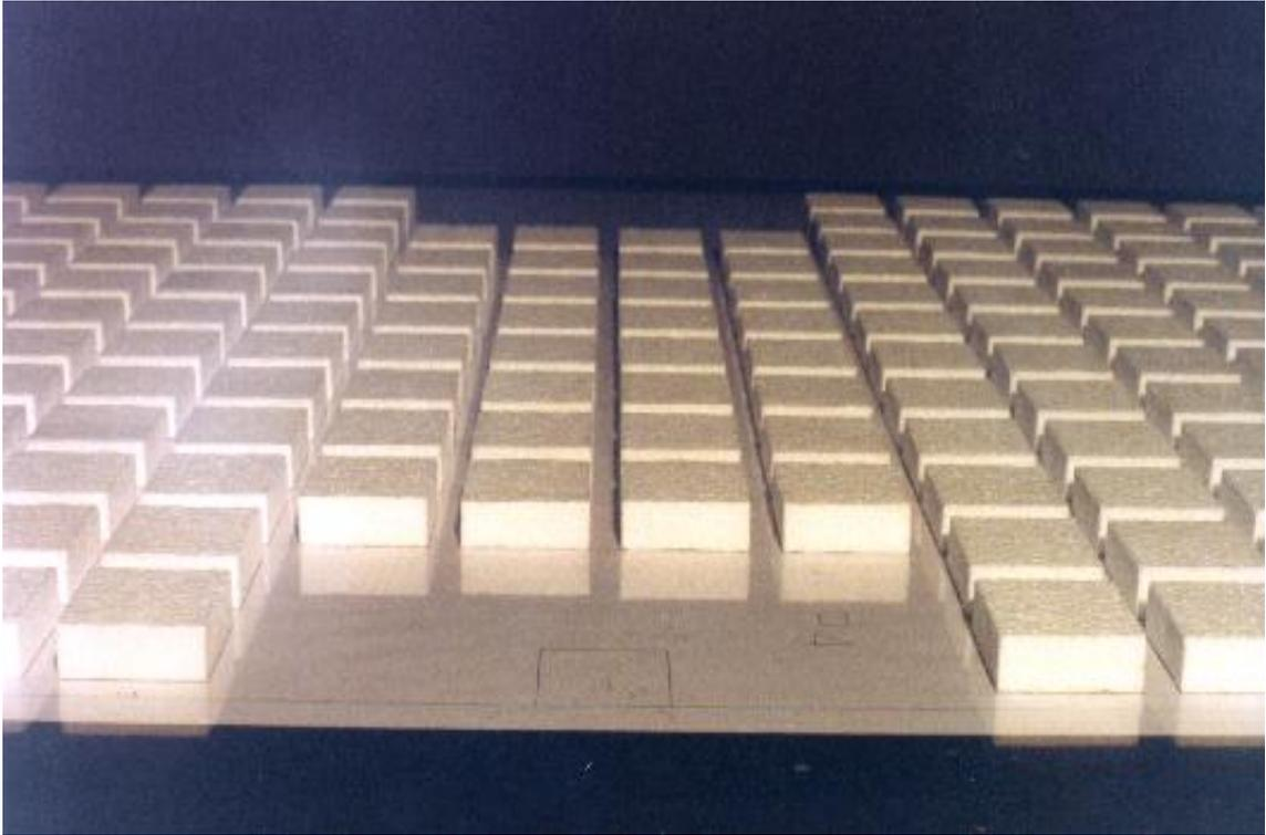
Foto 3.5 - Detalhe da fôrma após a colagem dos blocos de poliestireno expandido
