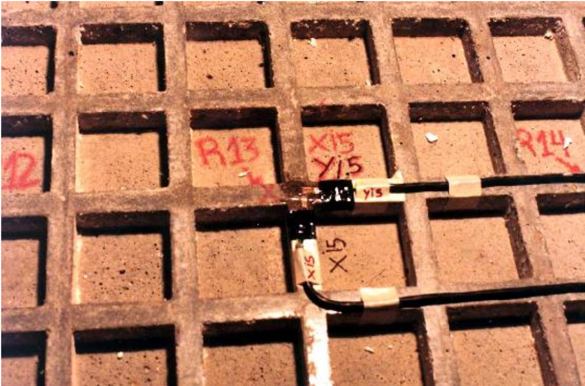
Foto 3.24 - Detalhe de extensômetros colados à superfície inferior do modelo, protegidos com verniz e com os cabos soldados e identificados
