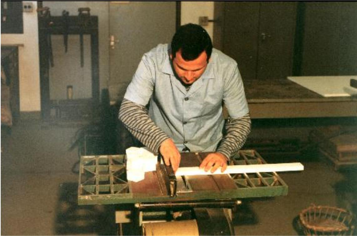
Foto 3.3 - Preparação dos blocos de poliestireno expandido na serra circular
