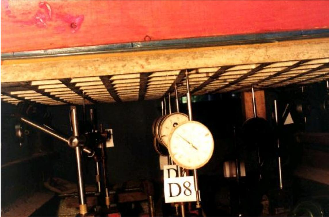
Foto 3.30 - Vista de alguns deflectômetros posicionados sob a laje, mostrando a camada de espuma e o filme plástico dispostos sobre a mesma
