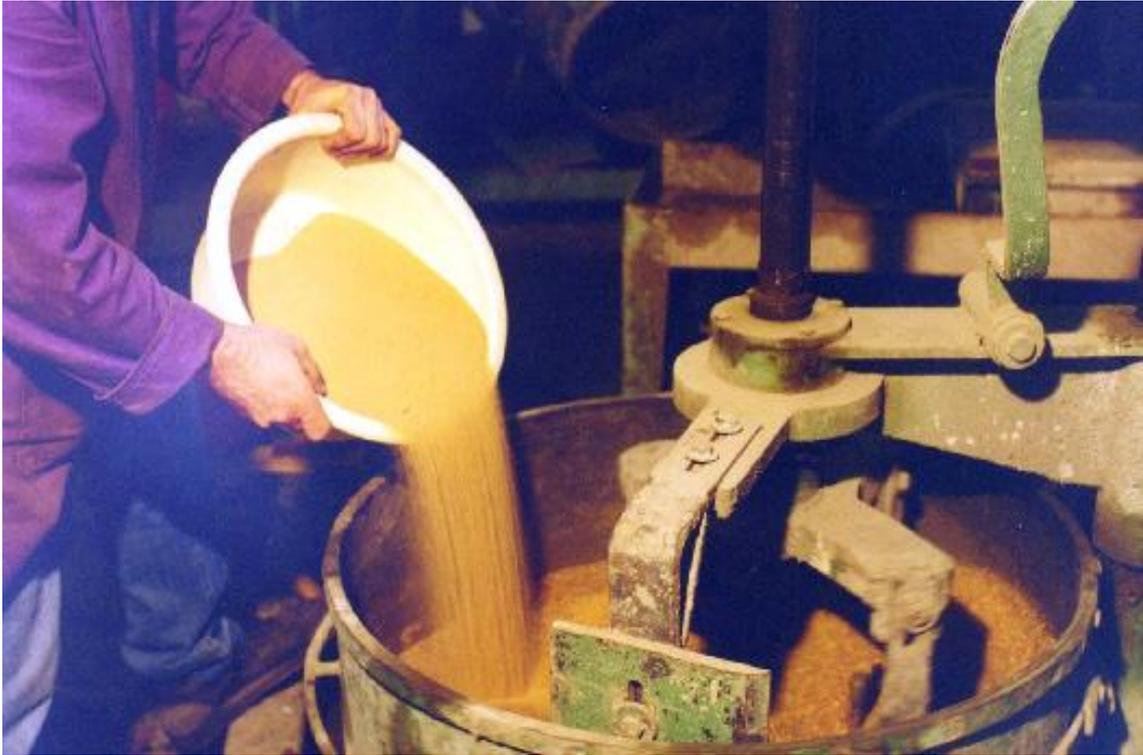
Foto 3.11 - Colocação dos agregados na betoneira
