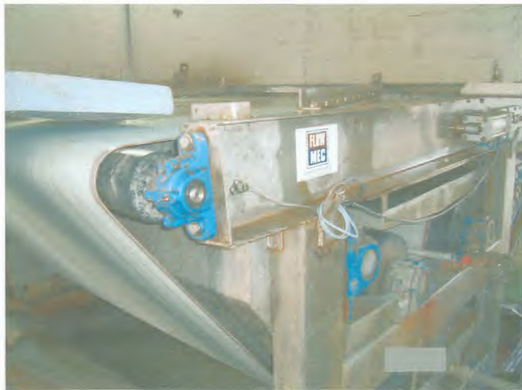
Figura 4.11 – Filtro desaguadora de lodo utilizado na indústria da fabricação do papel.
