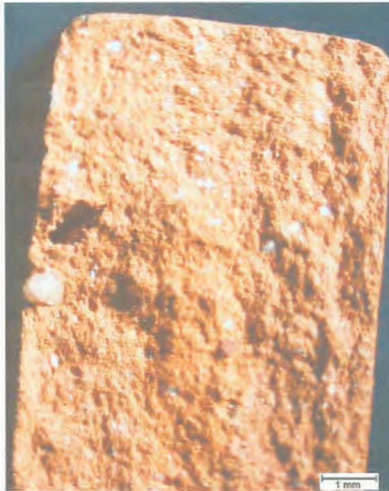
Figura 6.13 – Face de ruptura para um corpo cerâmico formulado com 10% de resíduo de celulose, evidenciando os prováveis defeitos concentradores de tensões que leva à ruptura. Na foto, pode-se questionar qual dos dois defeitos (o grão de quartzo, perto da superfície do corpo-de-prova) ou o poro (avantajado no seu tamanho, mas mais afastado da superfície) foi o maior defeito (Aumento: 10X).
