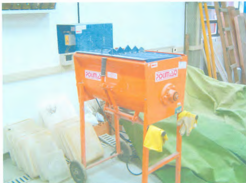
Figura 5.6 – Argamassadeira usada na homogeneização do material.
