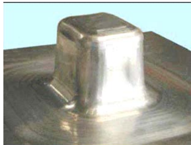
Figura 2.18- Exemplo de uma peça realizada através da estampagem multiestágios. Fonte: Hirt, 2004.
