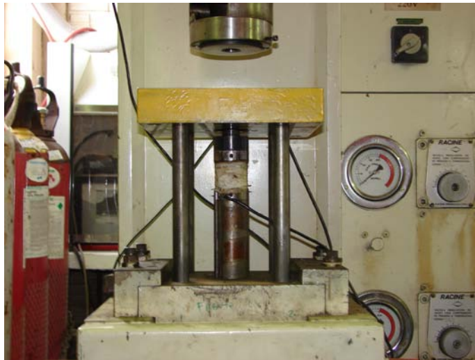
Figura 5.4 - Equipamento utilizado para ensaio Erichsen. Fonte: LDTM UFRGS 2006.
