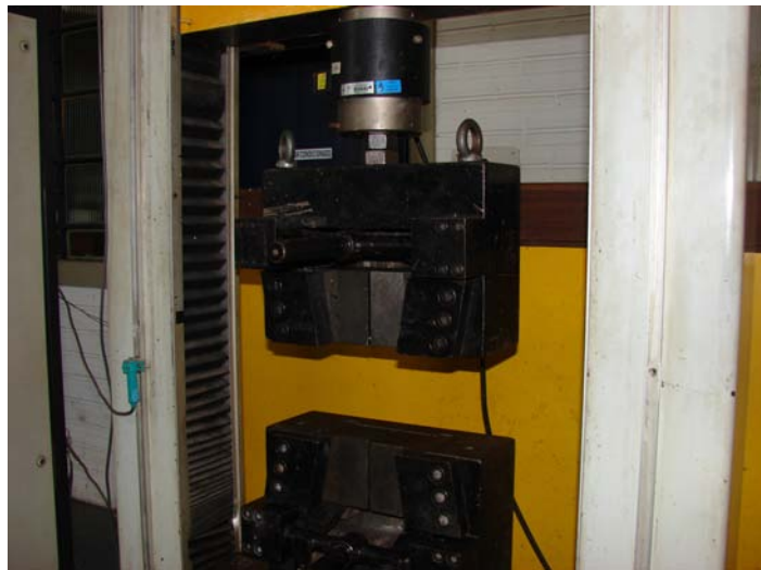
Figura 5.2- Máquina de ensaio utilizada no teste de tração. Fonte: LDTM UFRGS 2006.
