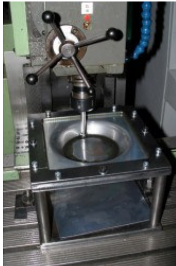
Figura 3.10 – Dispositivo utilizado em um processo de estampagem incremental não assistido por matriz. Fonte: Leuven, 2006.
