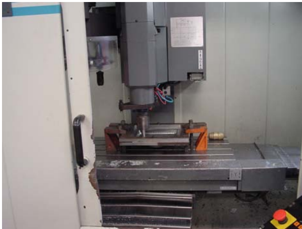
Figura 4.2 - Centro de usinagem vertical utilizado nos ensaios
