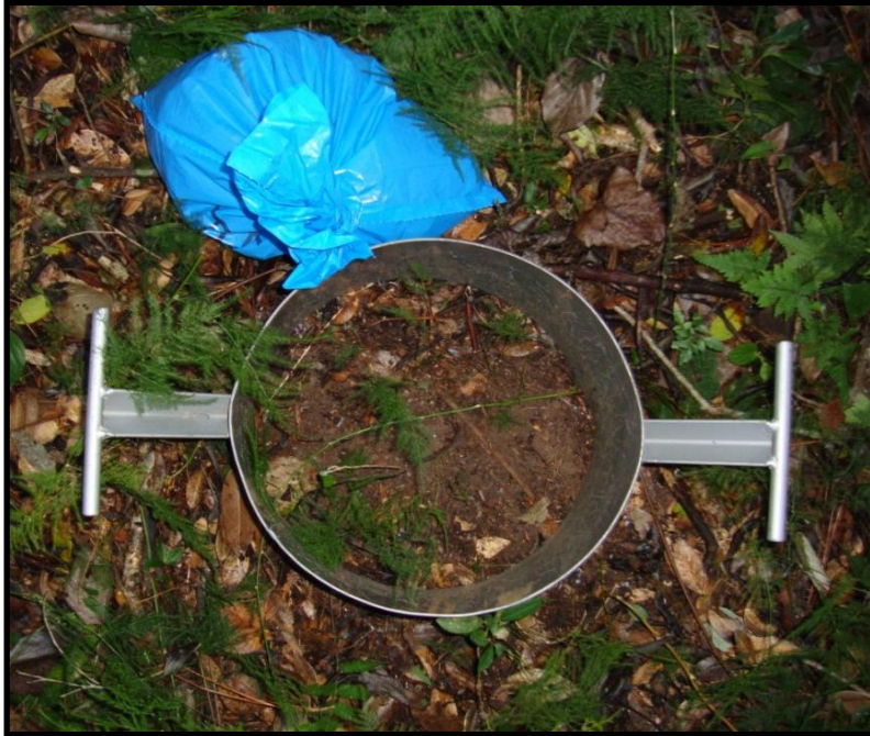
Figura 7. Amostrador circular de ferro de 30 cm de diâmetro, utilizado para a demarcação dos pontos de coleta dos quadrantes sorteados.
