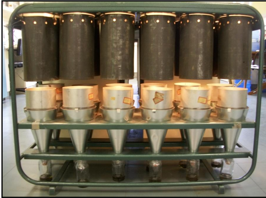
Figura 8. Aparato com 12 funis de Berlese, onde o restante de solo de cada amostra foi exposto à luz incandescente (25W) durante 72h.
