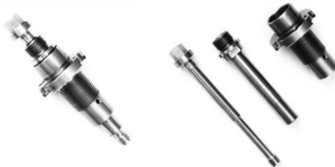
Figura 21: Ferramenta de soldagem utilizada na produção das soldas com seus componentes.
