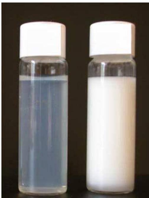
Figura 30. Imagem de uma microemulsão (esquerda) e uma macroemulsão (direita) com tamanhos de gota de 35 nm e 1  $\mu$ m, respectivamente. Extraído de Solans *et al.*<sup>134</sup>.
