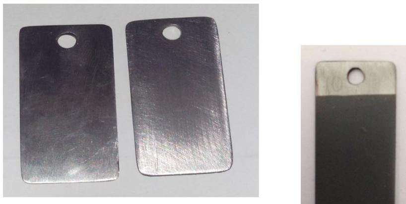
Figura 41. Exemplo de placas de aço 1020 polidas e pintadas.
