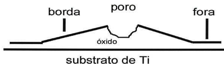
Figura 31 – Desenho esquemático que mostra os locais escolhidos sobre o óxido crescido por anodização ate centelhamento, onde foram feitas as análises de EDS
