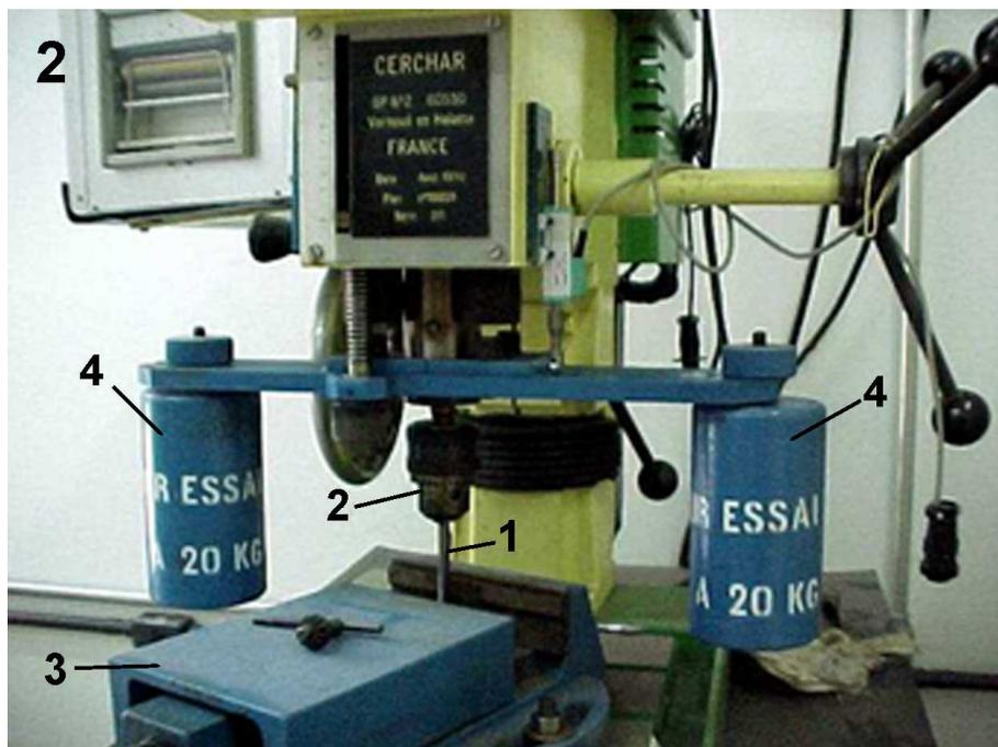
**Figura 18-** Equipamento para ensaio de dureza CERCHAR; vista de detalhe. 1-broca; 2-mandril; 3-morça; 4- carga
