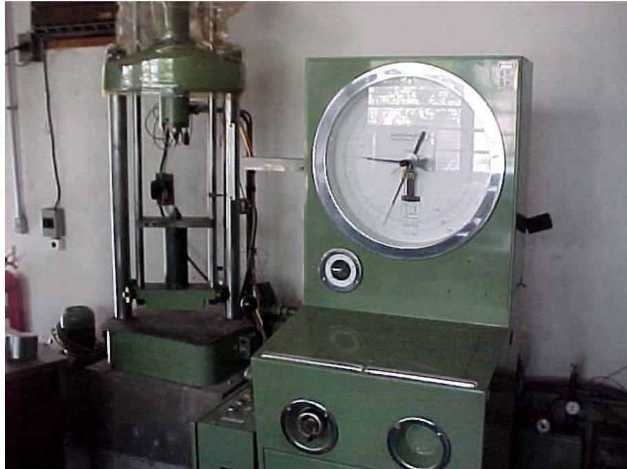
**Figura 8-** Prensa para ensaio de carga pontual.
