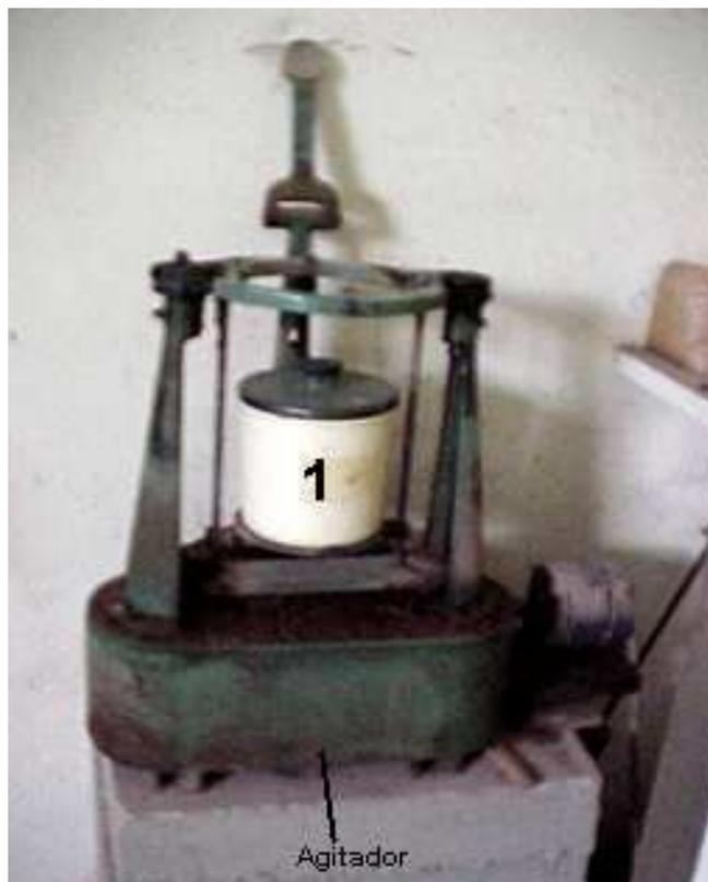
**Figura 6-** Agitador de peneiras para simular ensaio de desgaste Washington. 1- Recipiente de plástico.
