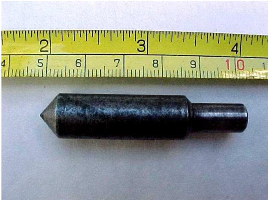
**Figura 12-** Ponteira do ensaio de abrasividade CERCHAR.
