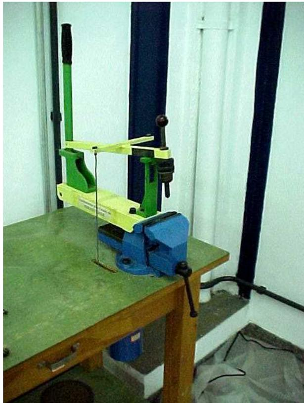
**Figura 11-** Equipamento para determinação da abrasividade CERCHAR.
