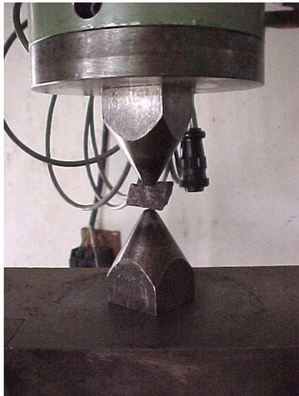
**Figura 10-** Ponteiras cônicas de aplicação de carga.
