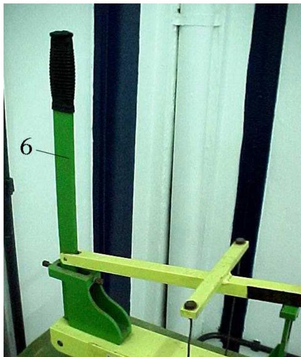
**Figura 15-** Detalhe da alavanca (6) do equipamento de abrasividade.
