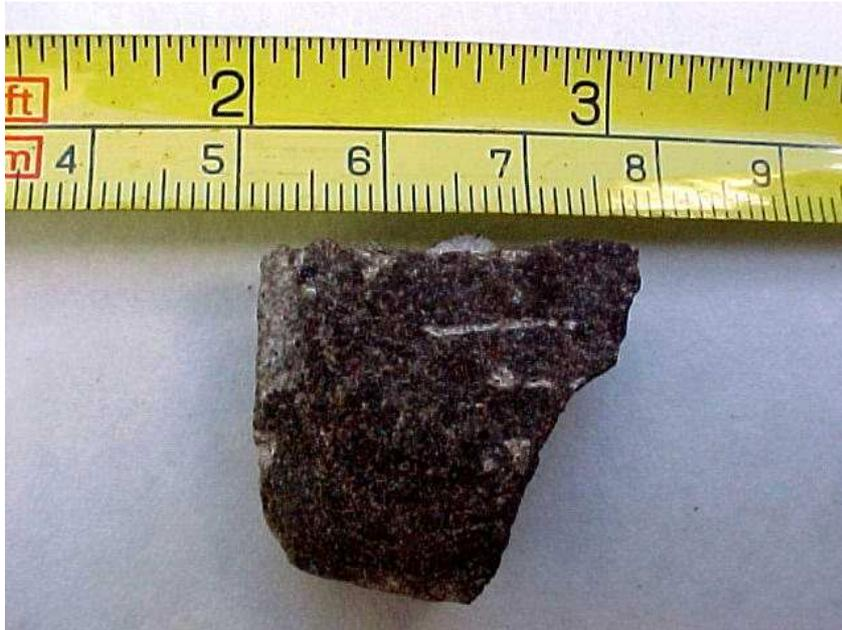
**Figura 16-** Sulco deixado pela ponteira na execução do ensaio.
