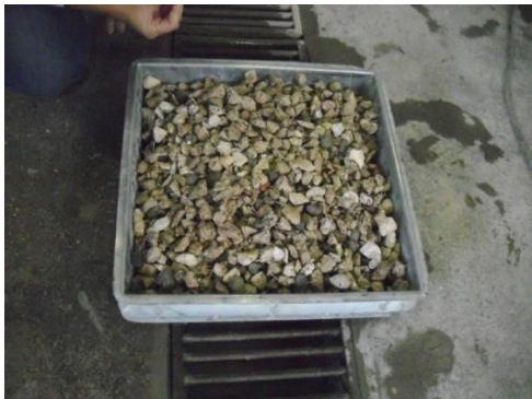
Figura 19 – RECOFI escorrendo água de saturação
