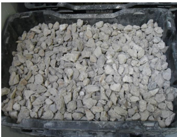
Figura 13 – Agregado graúdo reciclado de concreto I
