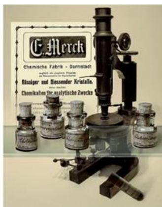
**Figura 2.** Fotografia do microscópio de luz polarizada e compostos líquido-cristalinos comercializados pela Merck em 1907 (Fonte: referência (5)).
