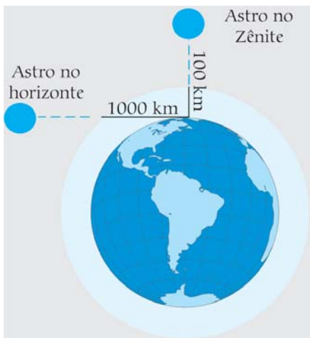
Figura 4 - Quando um raio de luz incide perpendicularmente à superfície terrestre, o seu caminho através da atmosfera é mínimo; quanto mais perto do horizonte se encontra o astro, mais longo é o percurso da luz dentro da atmosfera.
