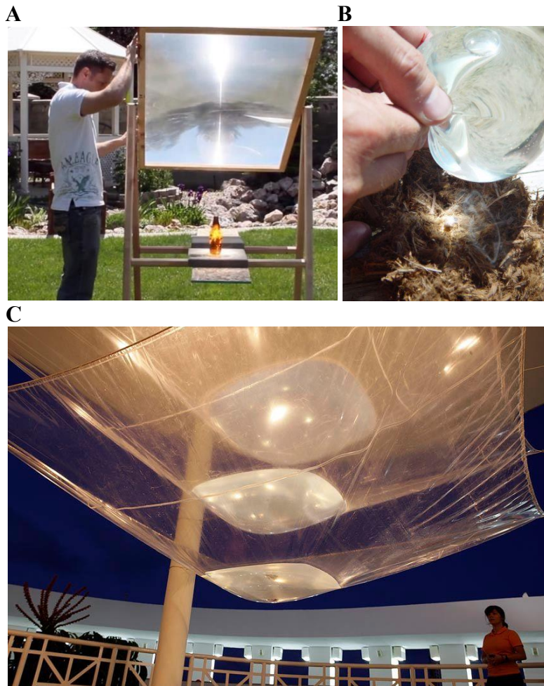
Figura 23 – (A) lente de televisão, (B) balão com água, (C) água sobre filme plástico.
