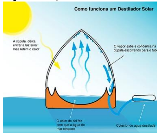
Figura 13 – Esquema de um destilador cônico.
