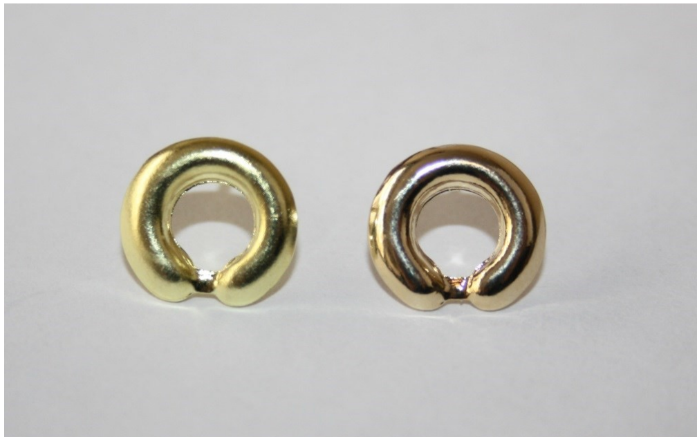
Figura 16 - Peça em latão à direita e peça idêntica após a galvanoplastia à esquerda.
