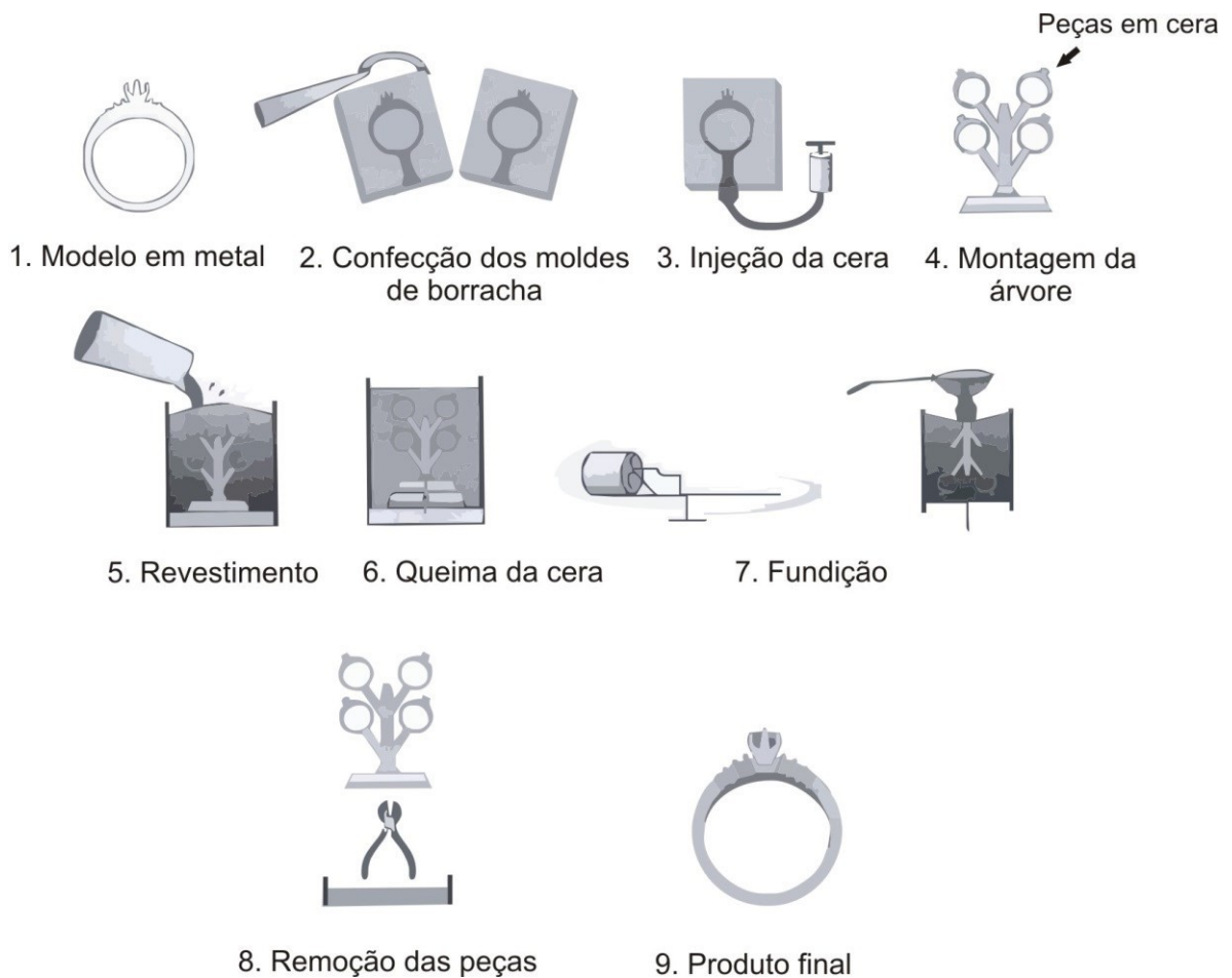
Figura 15 - Esquema do processo de fundição por cera perdida.
