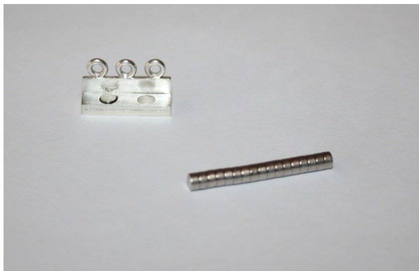
Figura 73 - Etapa de colagem dos ímãs de Neodímio na peça em Prata 750.
