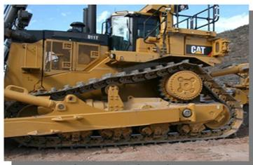
✓ Projetado para operar em materiais rochosos, o chassi montado elasticamente prolonga a vida útil do componente.
