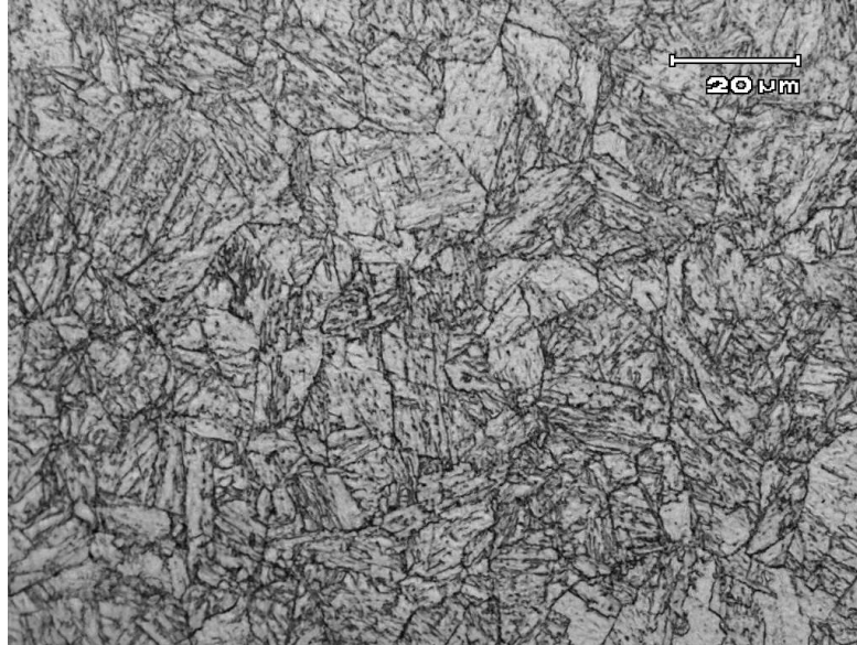
Figura 4.6 – Microestrutura do material 5,5Ni com tratamento de têmpera e revenido.
