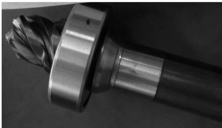
Figura 5.7 Imagem do pinhão de aço SAE 5120 cementado com camada 0,75mm rompido no teste
