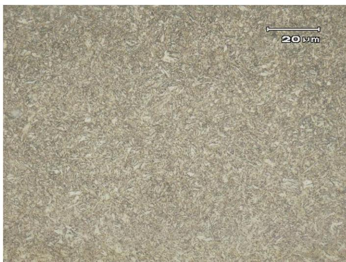
Figura 5.19 A microestrutura da camada de cementada do aço SAE 4320
