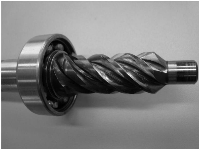
Figura 5.18 Imagem do pinhão de aço SAE 4320 cementado com 0,45 mm de camada, após ter rodado com carga de 30 kN e 250 Nm.
