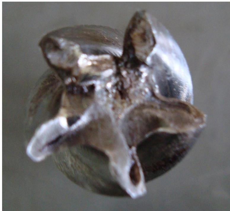
Figura 5.14 Pinhão de aço SAE 5120 com camada de 0,45 mm fraturado no teste de torção.
