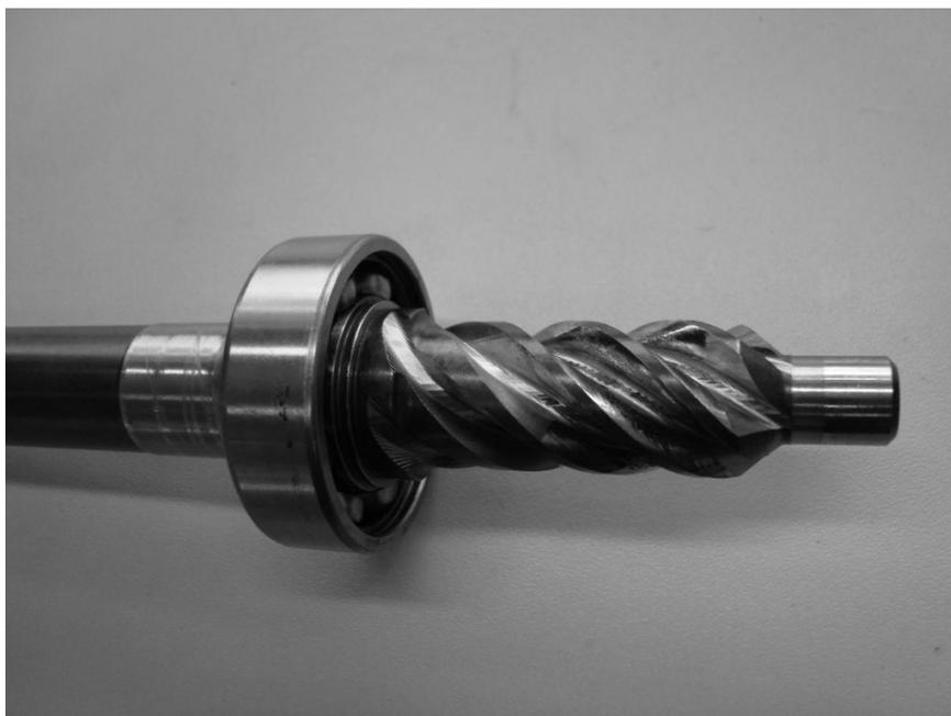
Figura 5.10 Imagem do pinhão cementado com 0,65mm de camada e dureza de núcleo 36 HRC (354HV), após ter rodado teste com carga na cremalheira de 22,5 kN e torque de 190 Nm
