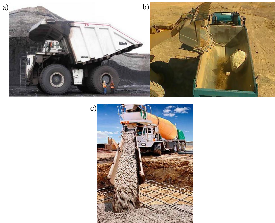
Figura 1.1 Exemplos de aplicações dos aços resistentes à abrasão. Caixa de carga de um caminhão utilizado para transporte em mineração (a), caixa de carga de um implemento rodoviário (b) e calha para descarregamento de concreto (c).
