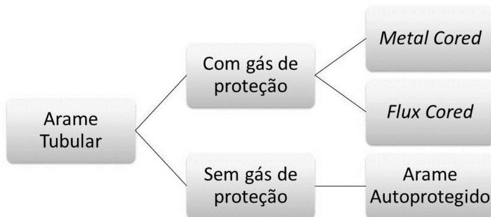
Figura 2.3 Fluxograma apresentando as variações da soldagem por arame tubular.
