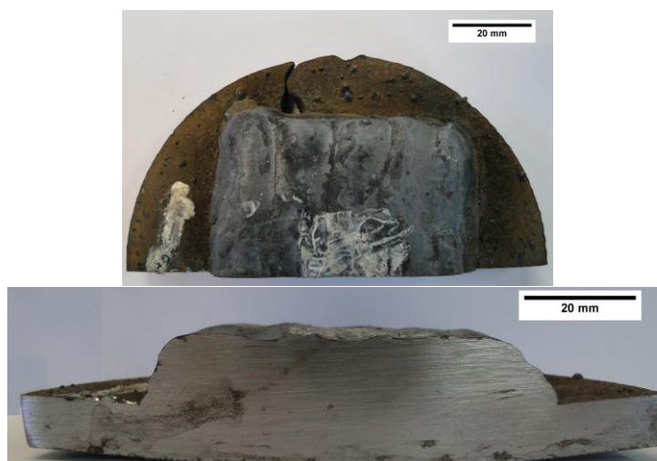
Figura 3. 15 Amostra utilizada para análise química do metal de solda.
