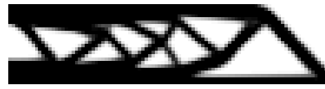
(b) 2304 ( 96 \times 24 ) elementos finitos
