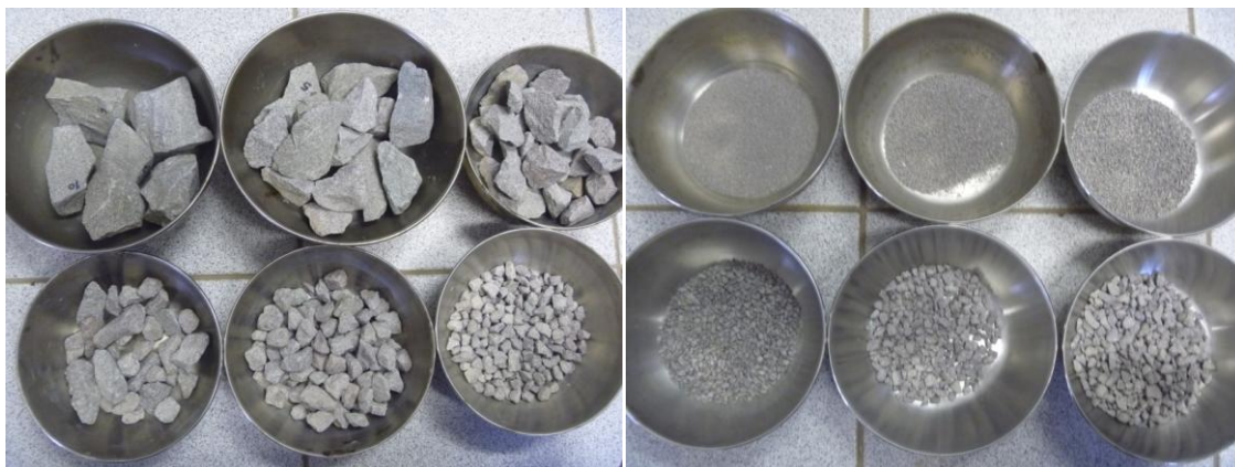
Figura 52: Riodacito antes do ensaio de durabilidade com sulfato de sódio. Fonte: Dados da pesquisa (2014).
