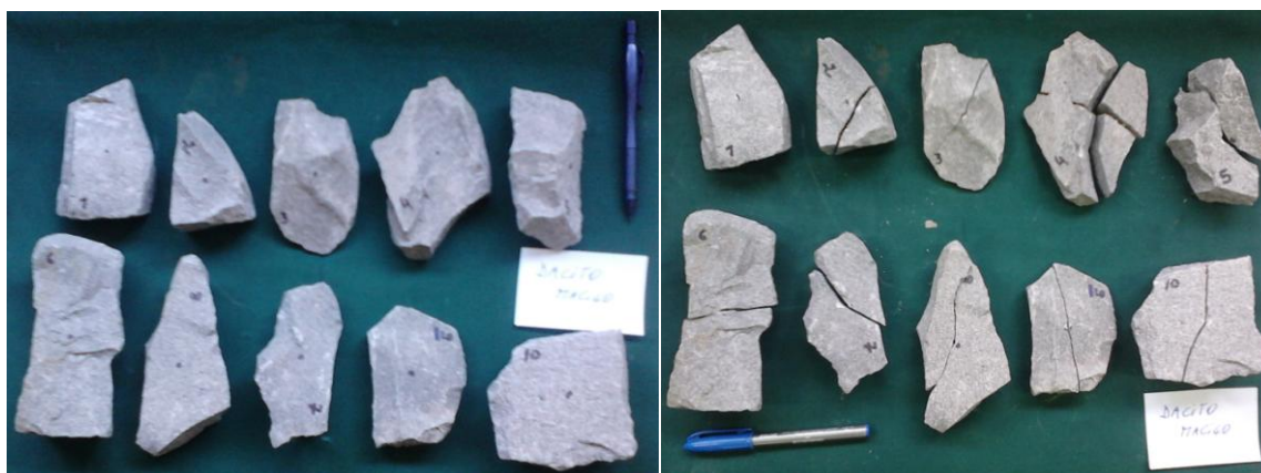
Figura 55: Riodacito antes do ensaio de carga pontual (esquerda) e após o rompimento (direita). Fonte: Dados da pesquisa (2014).
