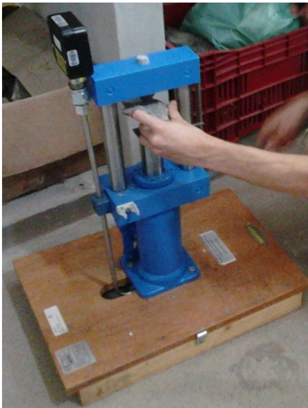
Figura 11: Aparelho utilizado no ensaio de carga pontual. Fonte: Dados da pesquisa (2014).
