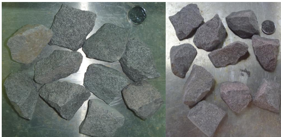
Figura 54: Riodacito antes do ensaio de alterabilidade a úmido. Dir.: Após o 5º ciclo do ensaio, mostrando pouquíssima fragmentação. Fonte: Dados da pesquisa (2014).
