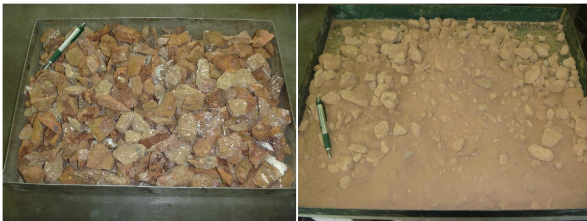
Figura 46: Esquerda: Brecha vítrea antes do ensaio de abrasão “Los Angeles”. Direita: Após o ensaio. Fonte: Dados da pesquisa (2014).
