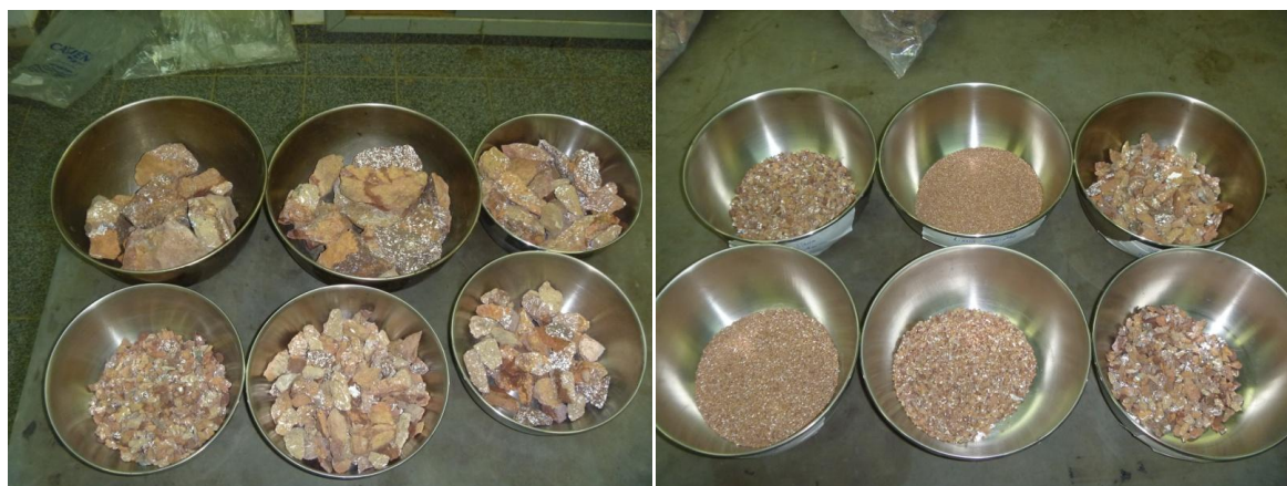
Figura 47: Esq.: Brecha vítrea antes do ensaio de durabilidade (frações de 50 a 9,5 mm). Dir.: Frações de 9,5 a 0,3 mm. Fonte: Dados da pesquisa (2014).
