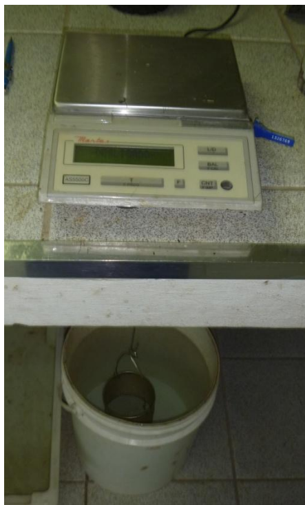
Figura 10: Balança com pesagem por baixo, cesto cilíndrico e tanque com água utilizados no ensaio de determinação dos índices físicos. Fonte: Dados da pesquisa (2014).
