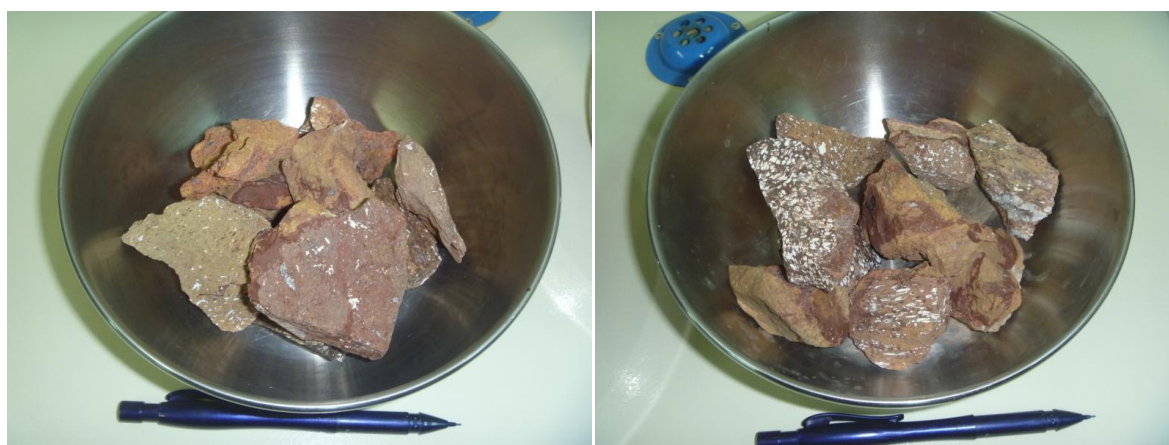
Figura 49: Amostras 1 (esquerda) e 2 (direita) da brecha vítrea antes do ensaio de alterabilidade a úmido (slak-durability). Fonte: Dados da pesquisa (2014).
