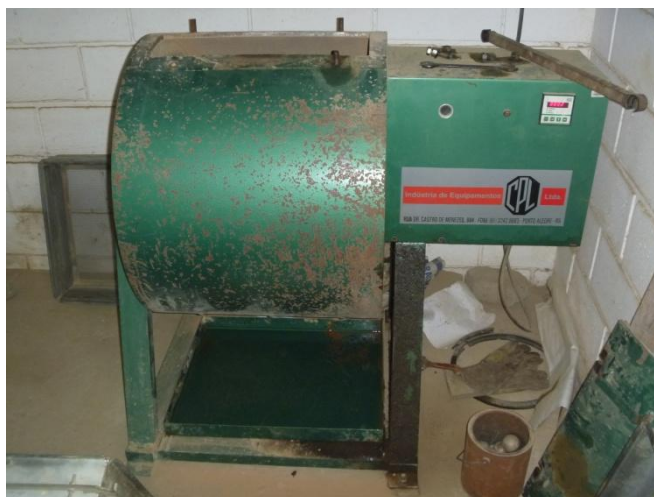
Figura 12: Máquina utilizada para o ensaio de Abrasão “Los Angeles”. Fonte: Dados da pesquisa (2014).
