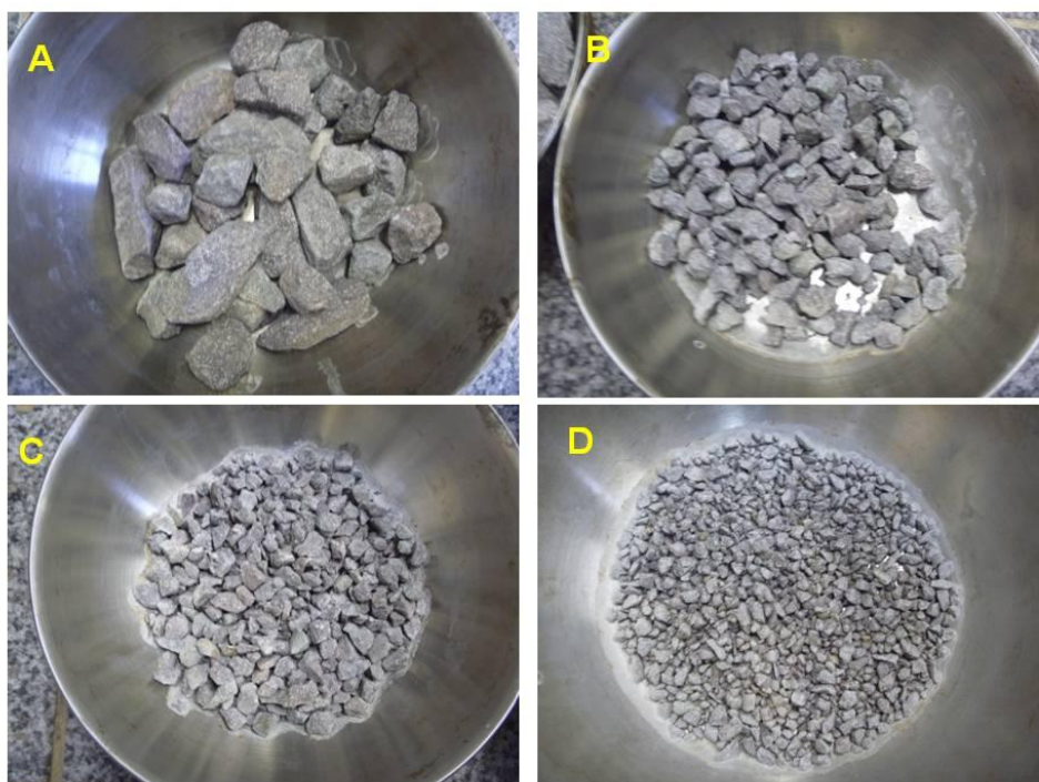
Figura 53: Algumas frações após o ensaio. Não houve fendilhamento e a degradação foi muito baixa. A: 19 mm. B: 9,5 mm. C: 4,8 mm. D: 2,4 mm. Fonte: Dados da pesquisa (2014).
