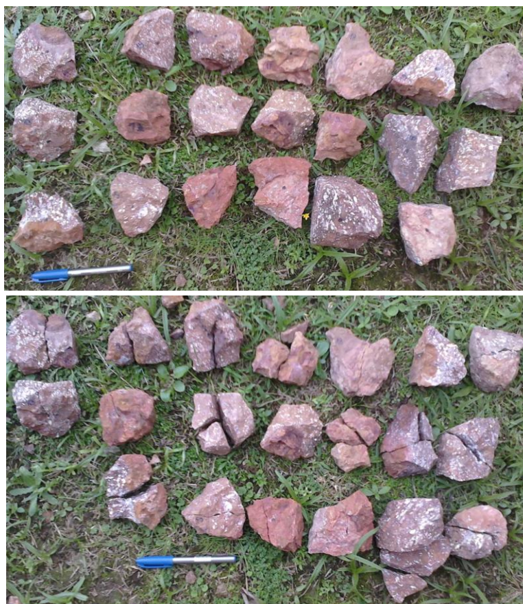
Figura 51: Brecha vítrea antes do ensaio de carga pontual (acima) e após o rompimento (abaixo). Fonte: Dados da pesquisa (2014).
