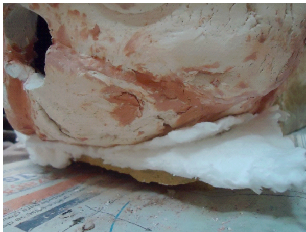
Figura 36: Peça que já passou pela primeira queima, agora com vidro e manta cerâmica, pronta para ir ao forno para derretimento do vidro.
