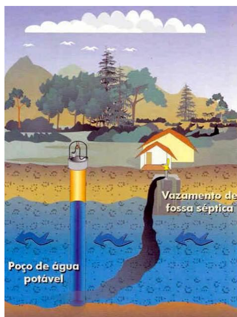
Figura 8 - Contaminação da água subterrânea por meio de vazamento de fossa séptica.
