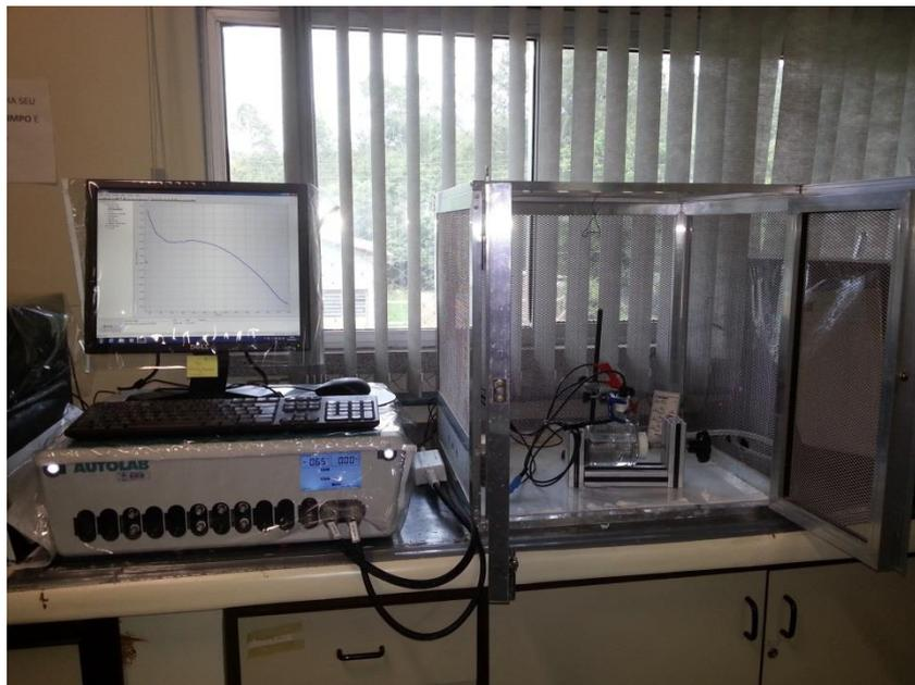
Figura 3.3 Aparato experimental utilizado para a realização das curvas de polarização potencioestáticas.
