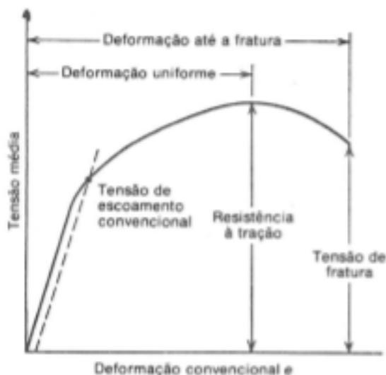
Figura 3.4 Curva tensão vs deformação de engenharia.
