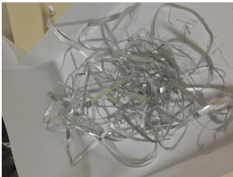
Figura 12. Imagem das fitas de alumínio silício produzidas com os parâmetros descritos no procedimento.
