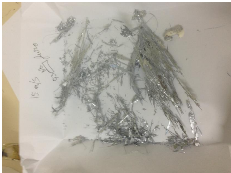
Figura 14. Fitas produzidas com uma velocidade tangencial da roda de cobre de 15\text{m/s} .
