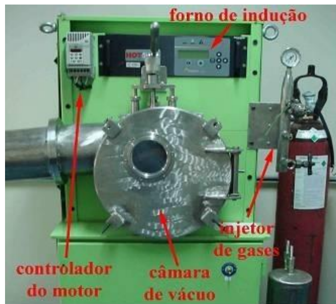
Figura 8. Imagem apresentando os componentes externos do melt spinner construído no Eletrocorr/UFRGS.
