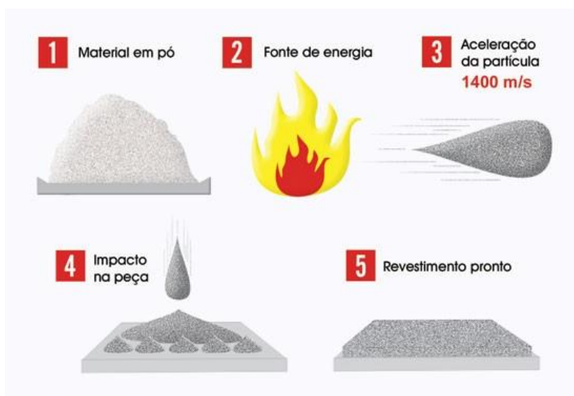
Figura 2.6 Esquema do processo de aspersão térmica tipo HVOF.
