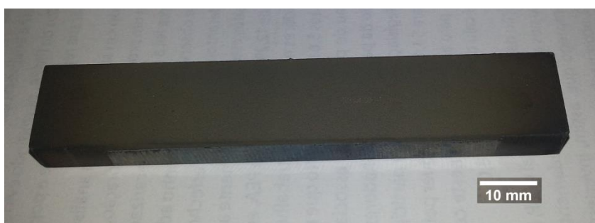
Figura 4.3 Revestimento de níquel sob o aço API 5CT P110 pelo processo de aspersão térmica HVOF.
