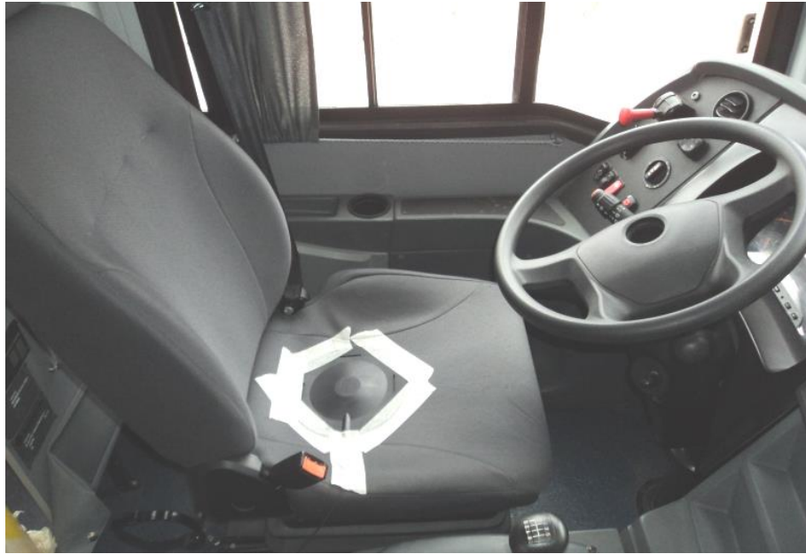
Figura 12 – Acelerômetro tipo seat pad instalado sobre o assento da poltrona do motorista.
