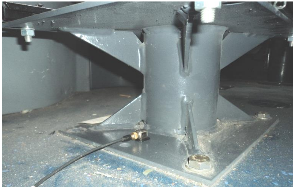
Figura 13 – Acelerômetro triaxial instalado na base da poltrona do motorista.
