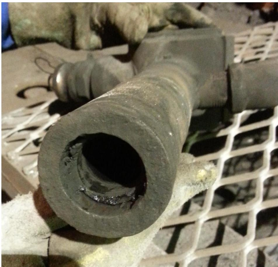
Figura 4.2 Em detalhe a ponta da injetora TSCi após seis meses em operação.
