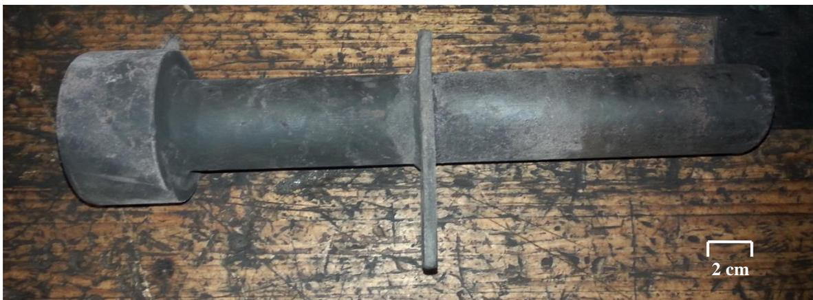
Figura 3.2 Injetora de carbono convencional utilizada no FEA.
