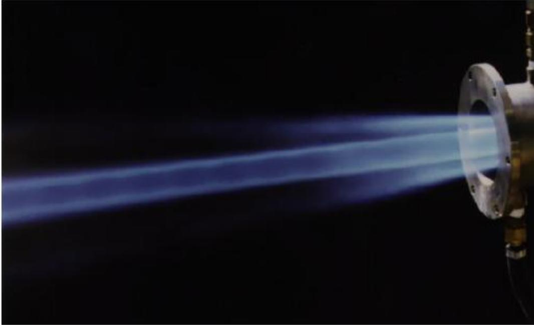
Figura 2.14 Jato supersônico protegido por um jato auxiliar. Fonte: JOHN, 2009.
