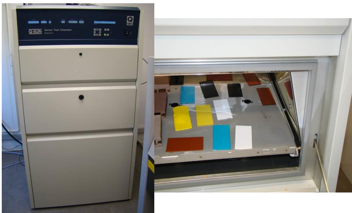
Figura 33: Câmara de envelhecimento “Xênon” e suporte para as amostras.
