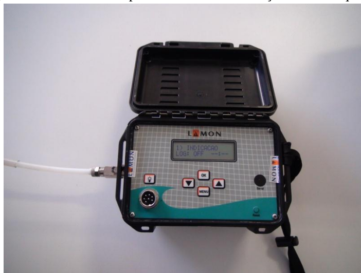
Figura 4.8 - Aparelho utilizado para medir a pressão na sucção e recalque da bomba.
