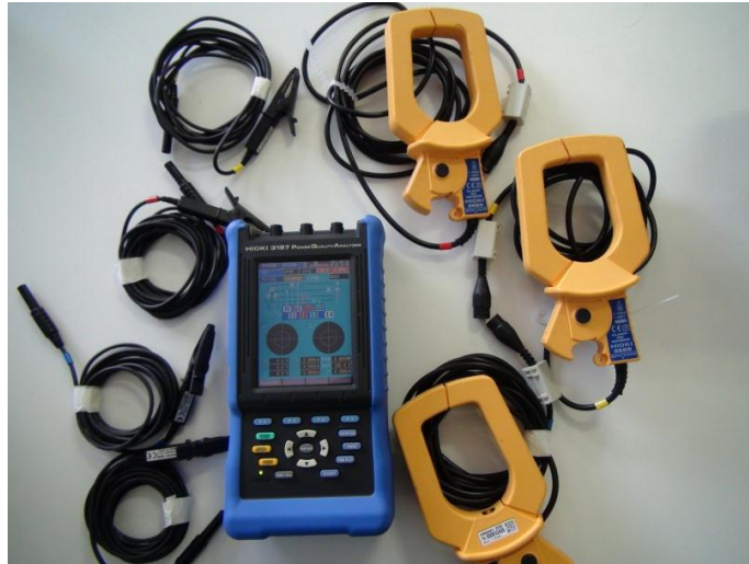
Figura 4.9 - Analisador de energia elétrica com as quatro ponteiros e três garras.
