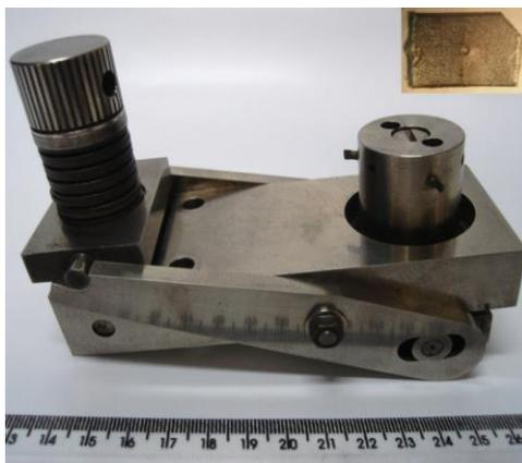
**Figura 3.2** – Fotos da DAC e gaxeta (acima e fora de escala) após a realização um processamento, no centro da marca na gaxeta, está o resíduo do material pressionado.
