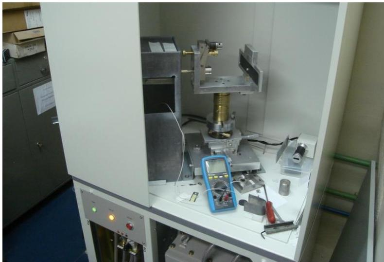
**Figura 3.7** – Difratorômetro de raios X por dispersão angular adaptado, equipamento utilizado para as medidas *in situ*, LAPMA.
