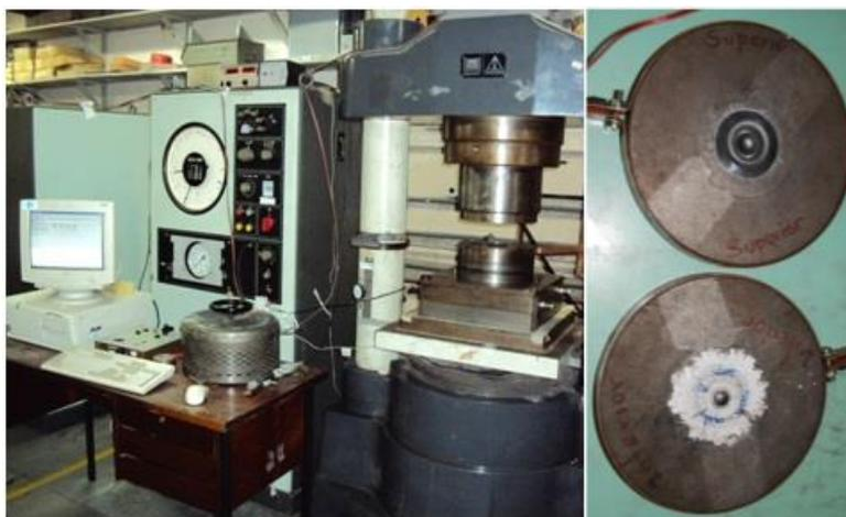
**Figura 3.1** – Fotos da prensa de 400 tonf e do conjunto de câmaras de Bridgman após a realização um processamento, em branco e no centro da câmara os resíduos, a gaxeta contendo o material pressionado.
