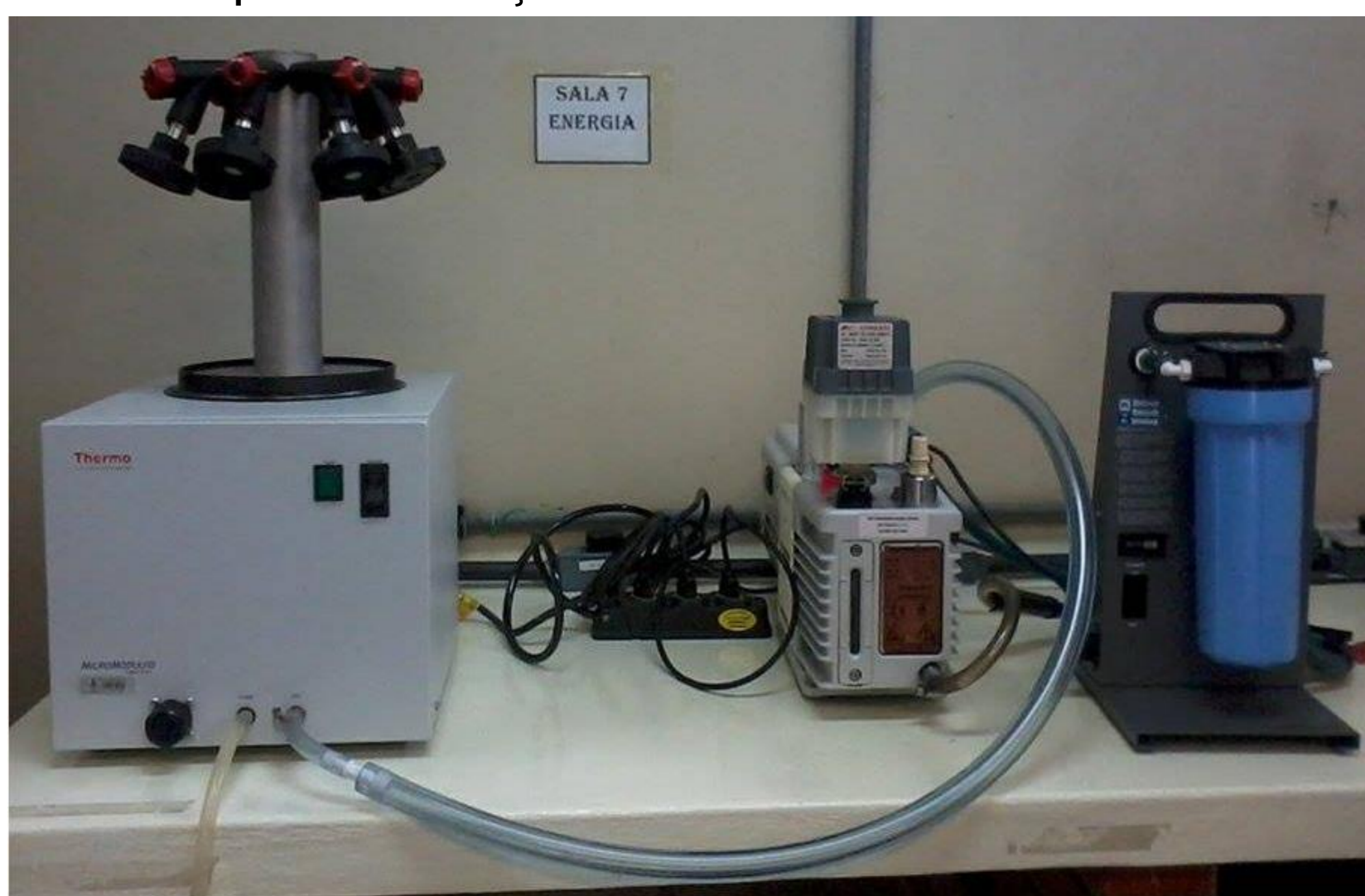
Figura 1. Liofilizador utilizado para remoção da umidade por sublimação.
