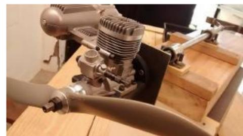
Figura 03: Bancada de desempenho dos motores.
