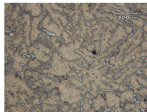
Figura 2: Microestrutura quase globular SAE 305. 100x.
