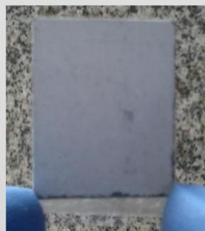
Figura 4 – Foto da amostra padrão de DMG com 4 horas de reação à 95°C;
