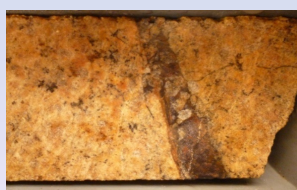
RS-078 – Aproximadamente 35m de profundidade. Fratura centimétrica preenchida com fluorita e material argilo-ferruginoso.
