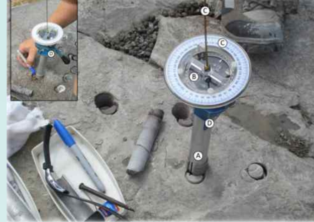
Figura 4. Orientador composto por uma haste cilíndrica oca; bússola magnética acoplada a esta haste e transferidor de 360° para as medidas de azimute solar.
