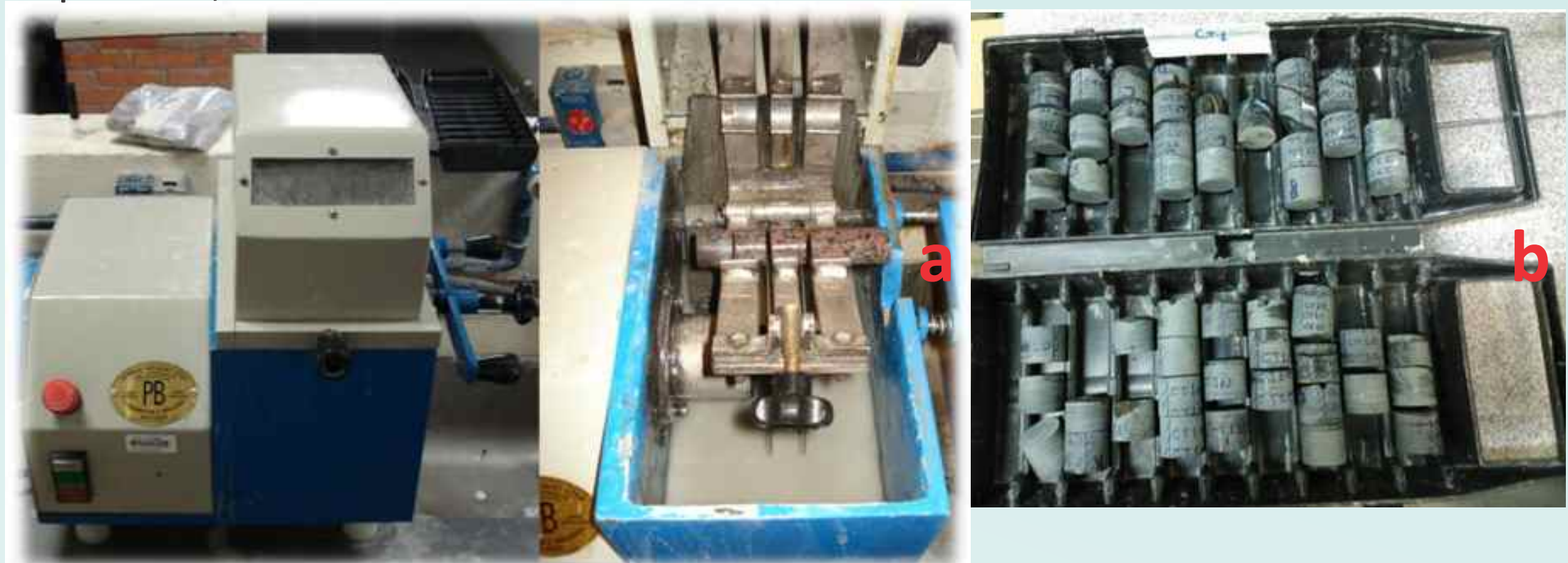
Figura 5. a) Serra utilizada para cortar os cilindros em espécimes. b) Espécimes já serrados.
