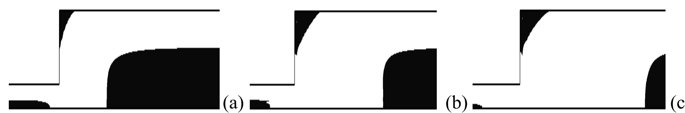
Figura 4: Zonas rígidas para U^*=1,0 , \theta^*=100 : (a) t^*=1 (b) t^*=15 e (c) t^*=25
