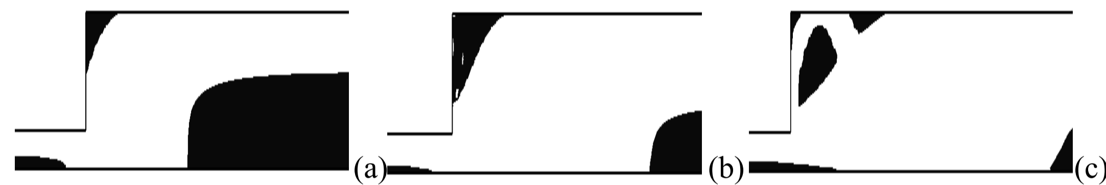
Figura 2: Zonas rígidas para \theta^*=100 e t^*=1,0 : (a) U^*=1 : (b) U^*=5 e (c) U^*=8
