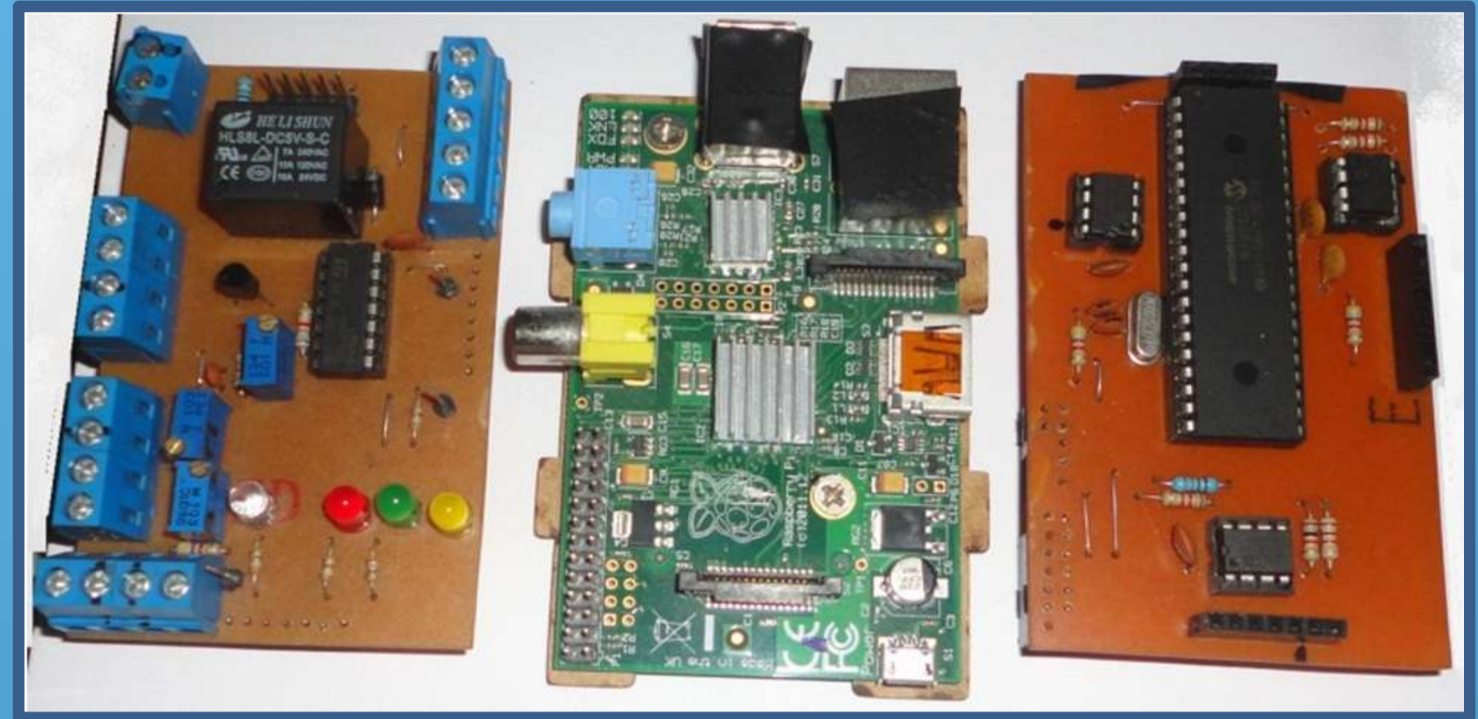
Figura 3 – Foto da placa RaspberryPI (centro) e das placas desenvolvidas e confeccionadas no LAMECC que fazem interface com o Raspberry, constituindo o módulo mecatrônico.
