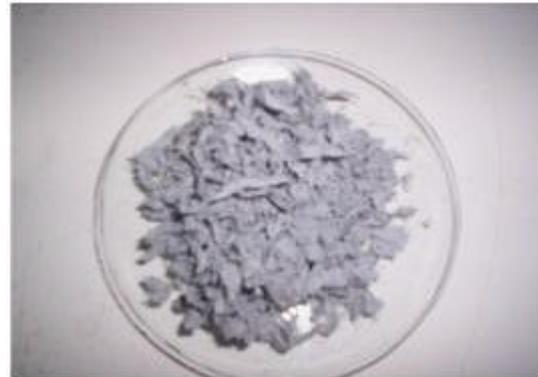
**Figura 2: Serragem do rebaixamento utilizada nos experimentos.**
