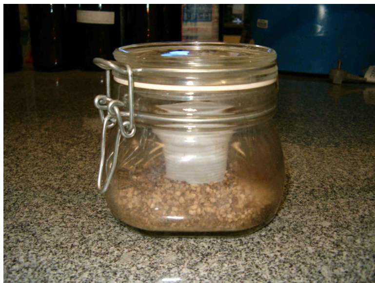
Figura 8 – Fotografia da célula respirométrica adaptada aos ensaios de degradação por microrganismos.
