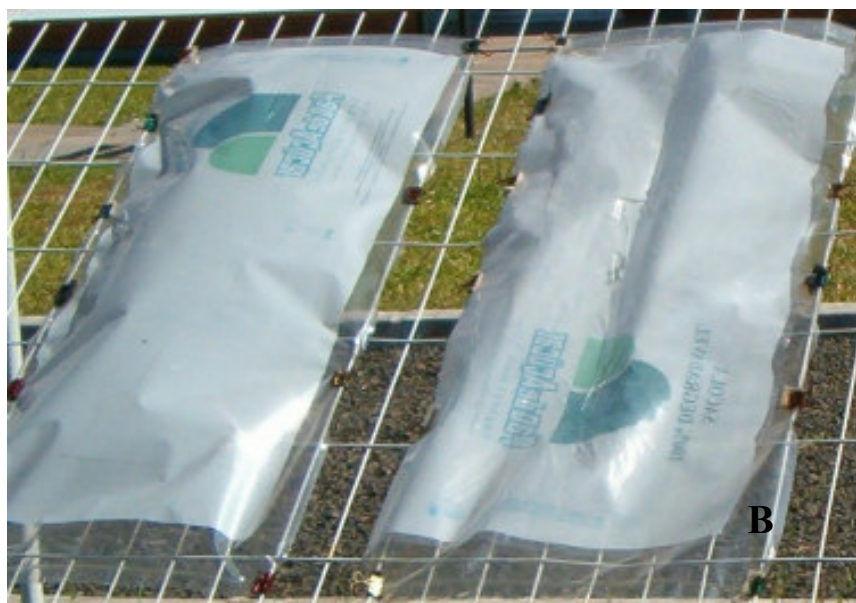
Figura 18 – Fotografias de sacolas de PE com 6 meses de exposição ao intemperismo, em condições de saturação de umidade (A) e umidade ambiente (B).
