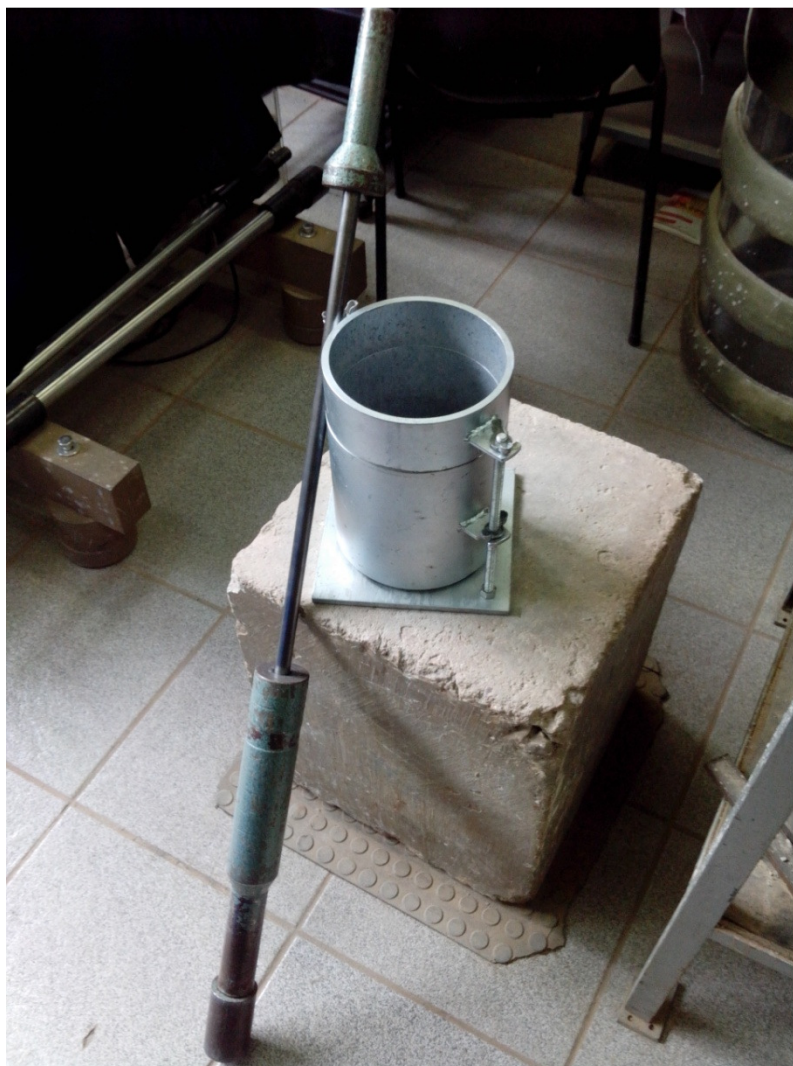
Figura 6 – Soquete grande e molde cilíndrico
