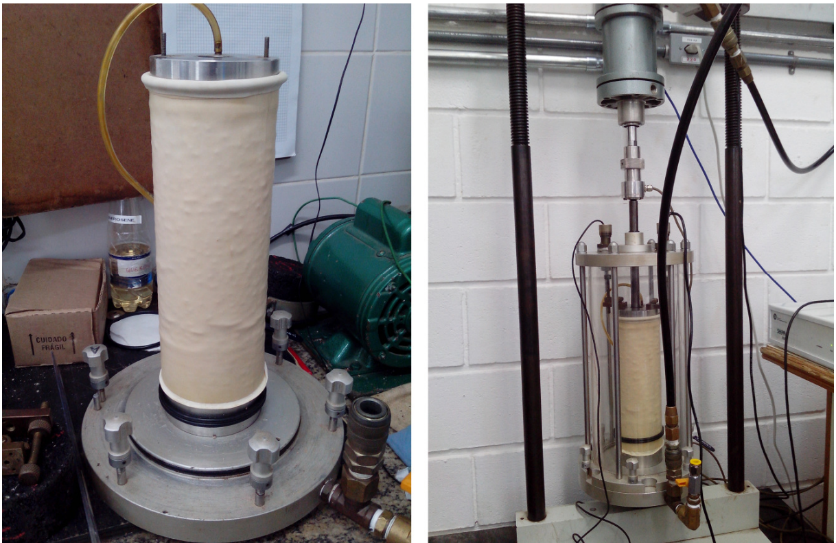
Figura 16 – Câmara triaxial aberta com cp (à esquerda) e fechada (à direita)
