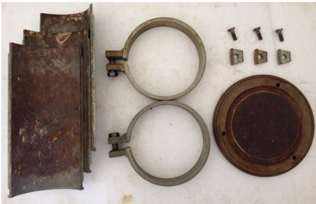
Figura 9 – Cilindro metálico tripartido desmontado
