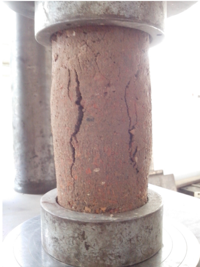
Figura 13 – Corpo de prova sem cimento após o ensaio de compressão simples
