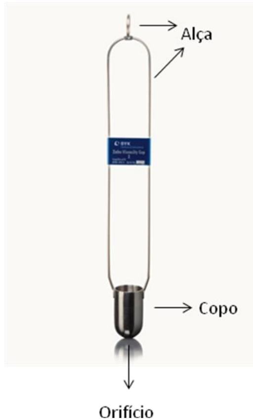
**Figura 3.2:** Representação do instrumento de medição de viscosidade Copo Zahn 2.
