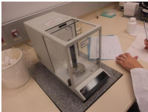
**Figura 4.6:** Procedimento para determinação da massa específica da tinta.
