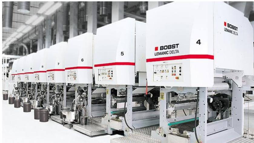
**Figura 2.1:** Modelo de impressora via rotogravura (Fonte: <<http://www.bobst.com>>. Acesso em 15 de maio de 2012).
