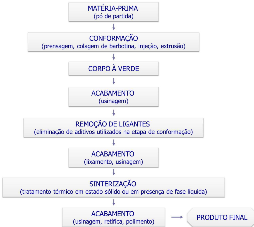
Figura 8: Fluxograma simplificado do processo de fabricação de cerâmicas avançadas.
