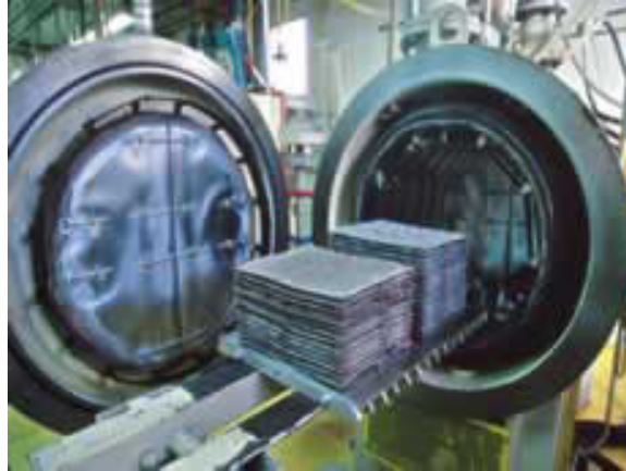
Figura 10: Reator para pré-sinterização híbrida (remoção dos ligantes via ataque por plasma e via tratamento térmico) [40].
