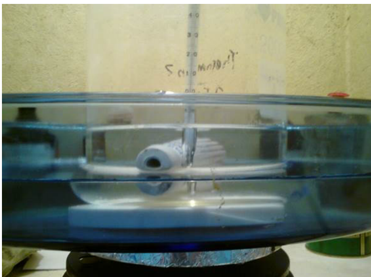
Figura 9: Bico de jateamento produzido em alumina por injeção em alta pressão (corpo à verde) durante a remoção química dos polímeros de baixo peso molecular utilizando hexano como solvente a 60°C.
