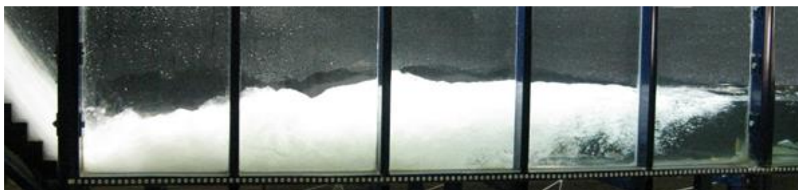
Figura 19: Imagem de um ressalto hidráulico clássico a jusante de um vertedouro em degraus, escoamento da esquerda para a direita. (Laboratório de Obras Hidráulicas, IPH/UFRGS)
