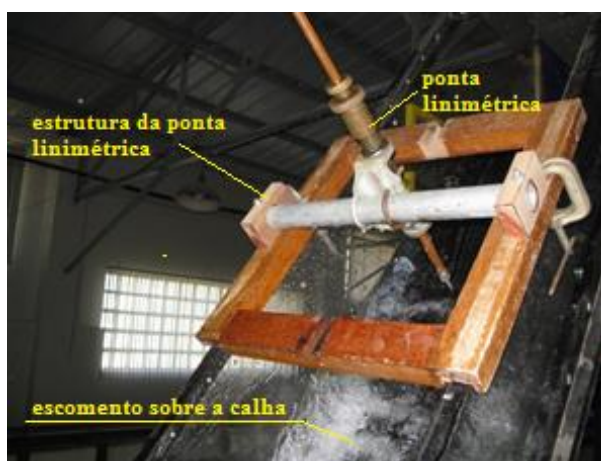
Figura 44: Instalação da ponta linimétrica sobre a calha
