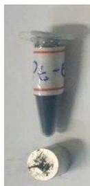
Figura 13 – Amostra de Pt\_100 para análise de EDS.
