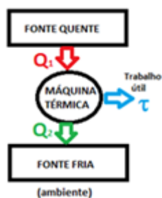
Figura 12: Esquema termodinâmico de uma máquina térmica.
