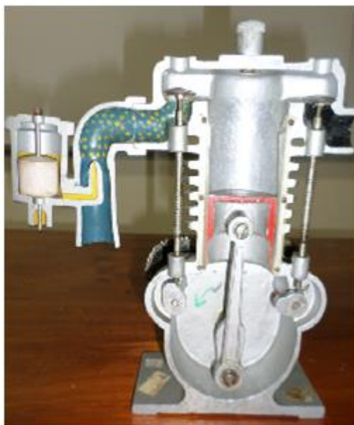
Figura 10: Simulador de motor à combustão de quatro tempos. Emprestado do IF da UFRGS.
