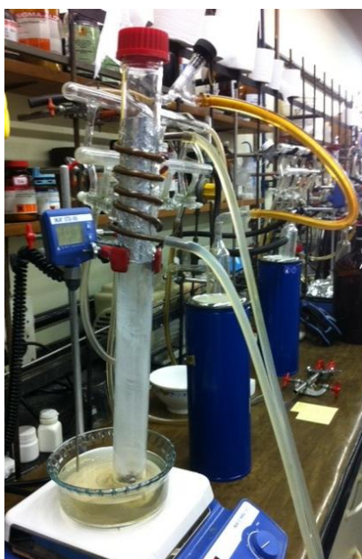
Figura 11: Foto da aparelhagem para a sublimação do \text{AlCl}_3 .
