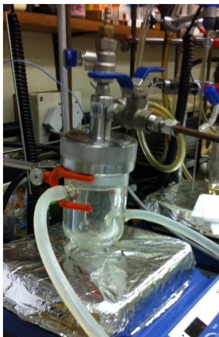
Figura 20: Reator de vidro
